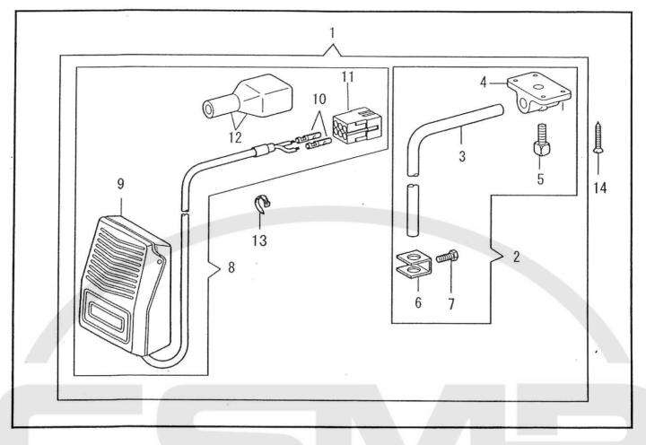
手動スイッチ関係(-BT, -CD, -DS)/Manual switch mechanism (-BT, -CD, -DS)
