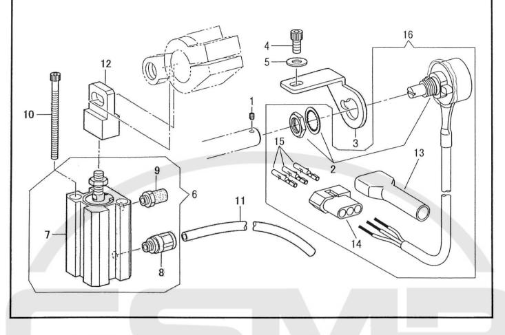
クイックバック関係 (-BT)/Quick reverse mechanism(-BT)
