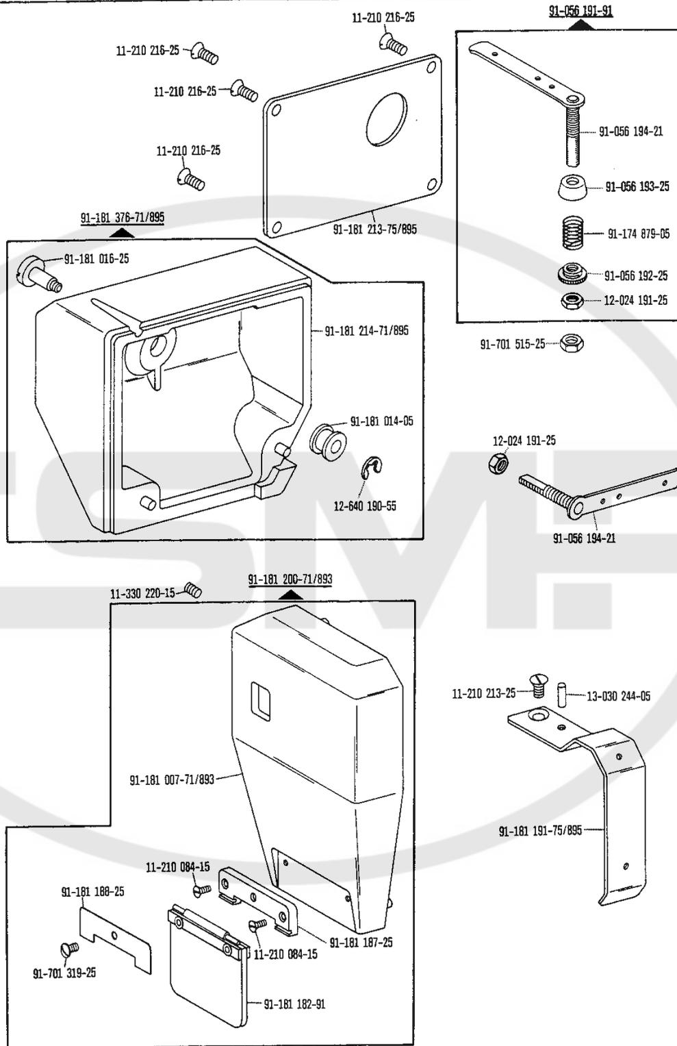
Gehäuse- und Sockelteile
