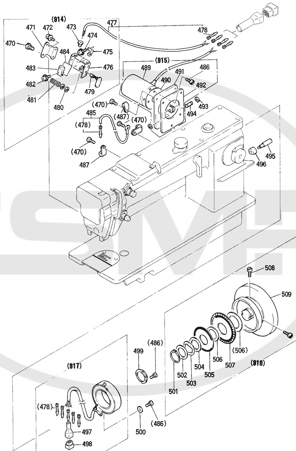
**⑨ タッチバック機構および検出器機構**
