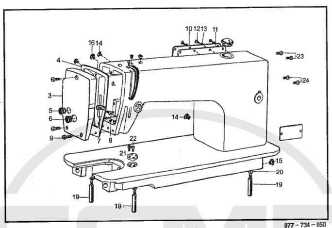
B. 膝上ゲ関係/Knee lifter mechanism/Kniehebel/Mécanisme de genouillère/
