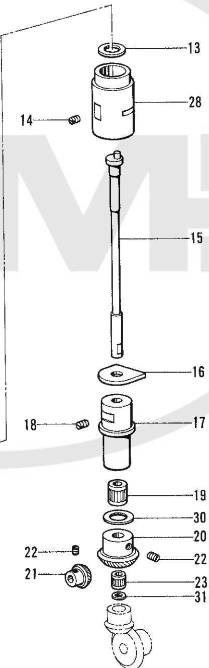
J2. カマ関係/Rotary hook mechanism/Greifervorrichtung/
