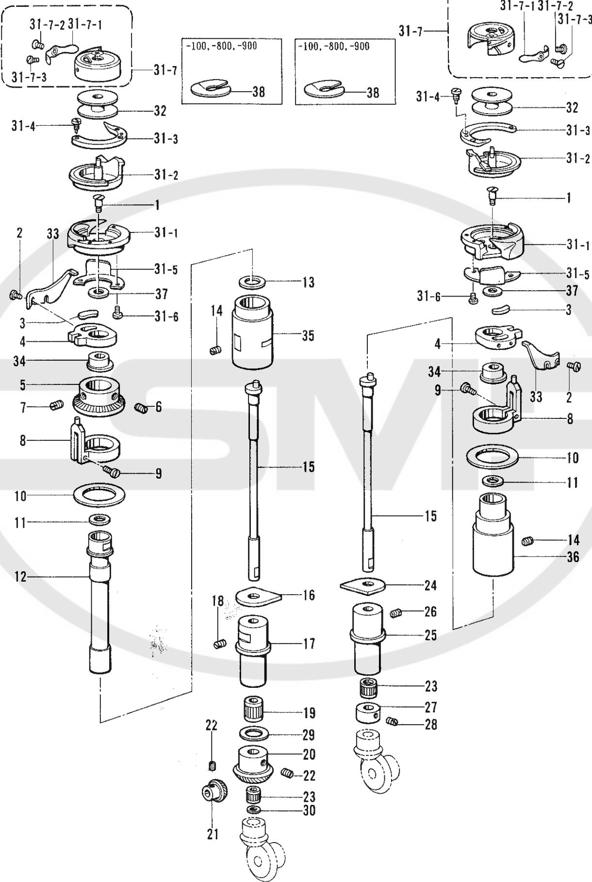
J4. カマ関係/Rotary hook mechanism/Greifervorrichtung/
