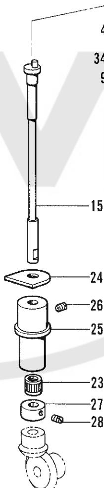
J4. カマ関係/Rotary hook mechanism/Greifervorrichtung/
