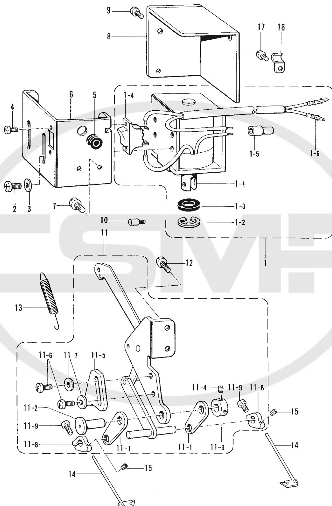
R. 糸扱い関係 (糸切り) / Thread wiper mechanism (Thread Trimmer) / Fadenwischvorrichtung (Fadenabschneider) /
