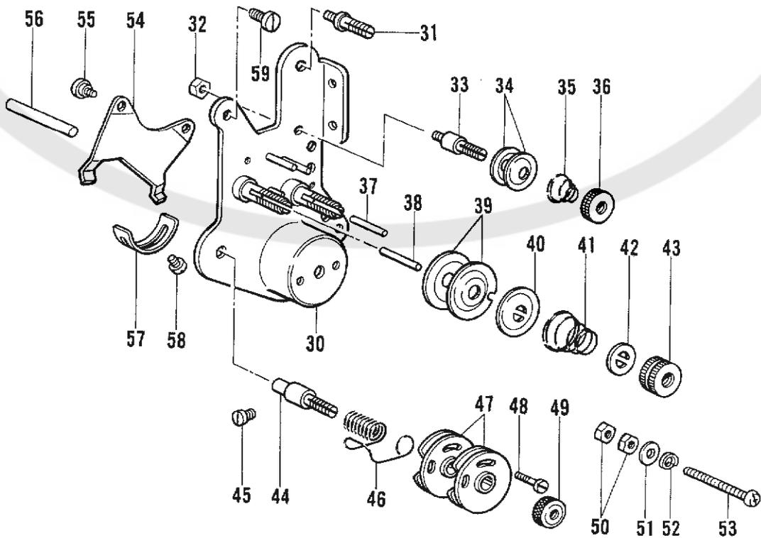
L3. 糸調子関係/Thread tension/Faderspannung/
