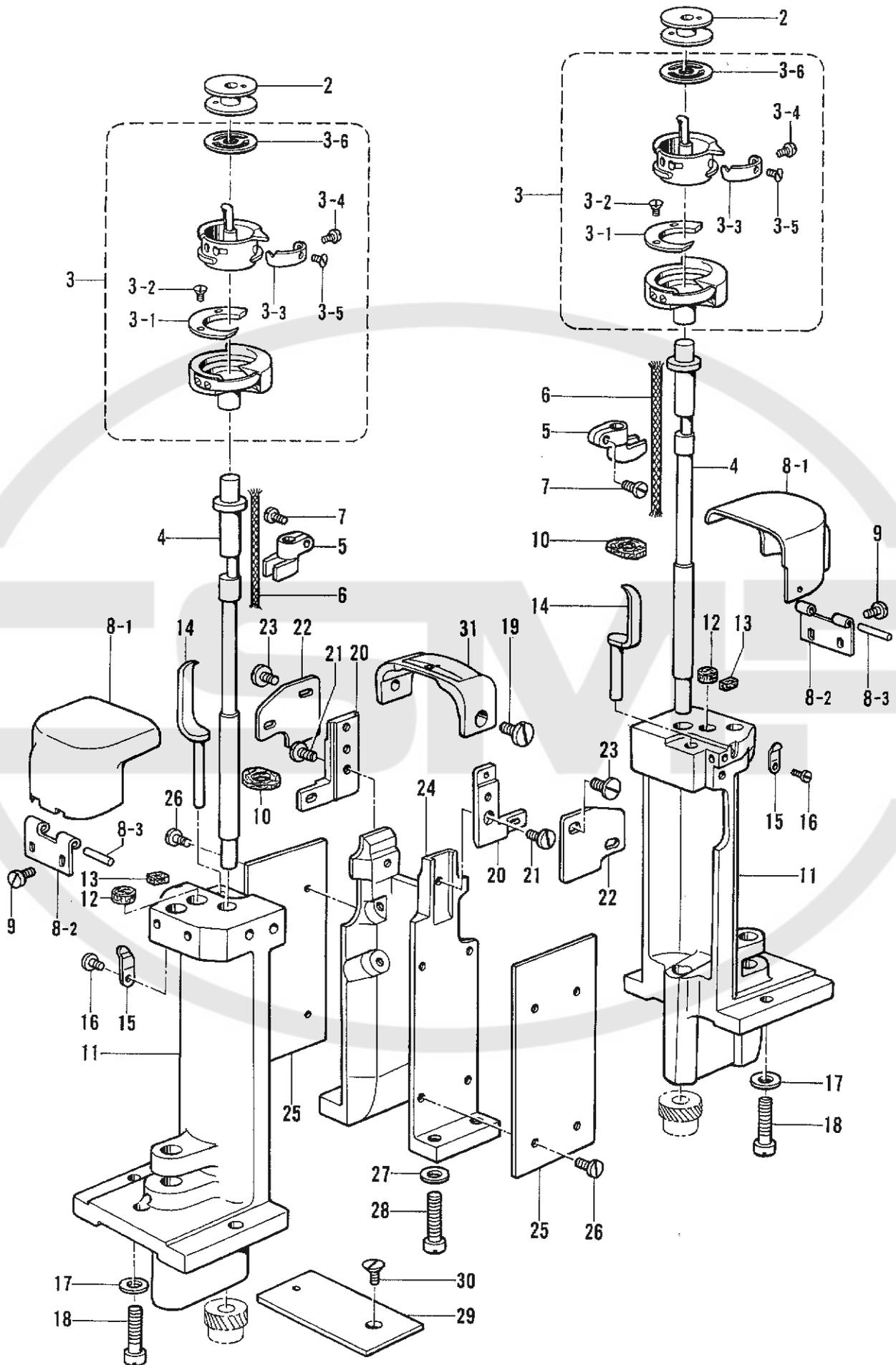
J2. カマ関係 / Rotary hook mechanism / Greifervorrichtung /
