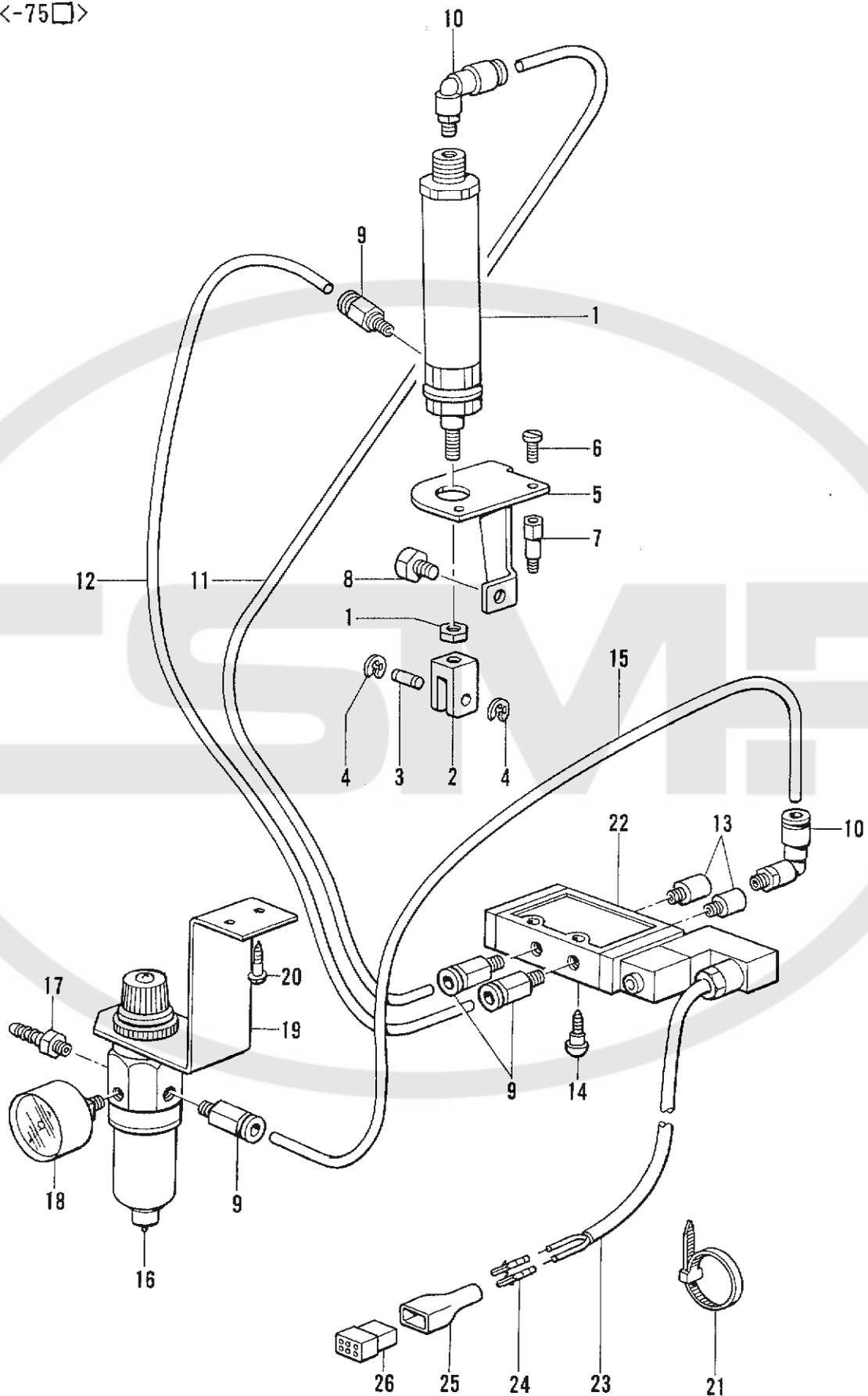
E. 押工上げ関係 /Work clamp lifter mechanism/Stoffhalterhebevorrichtung/
