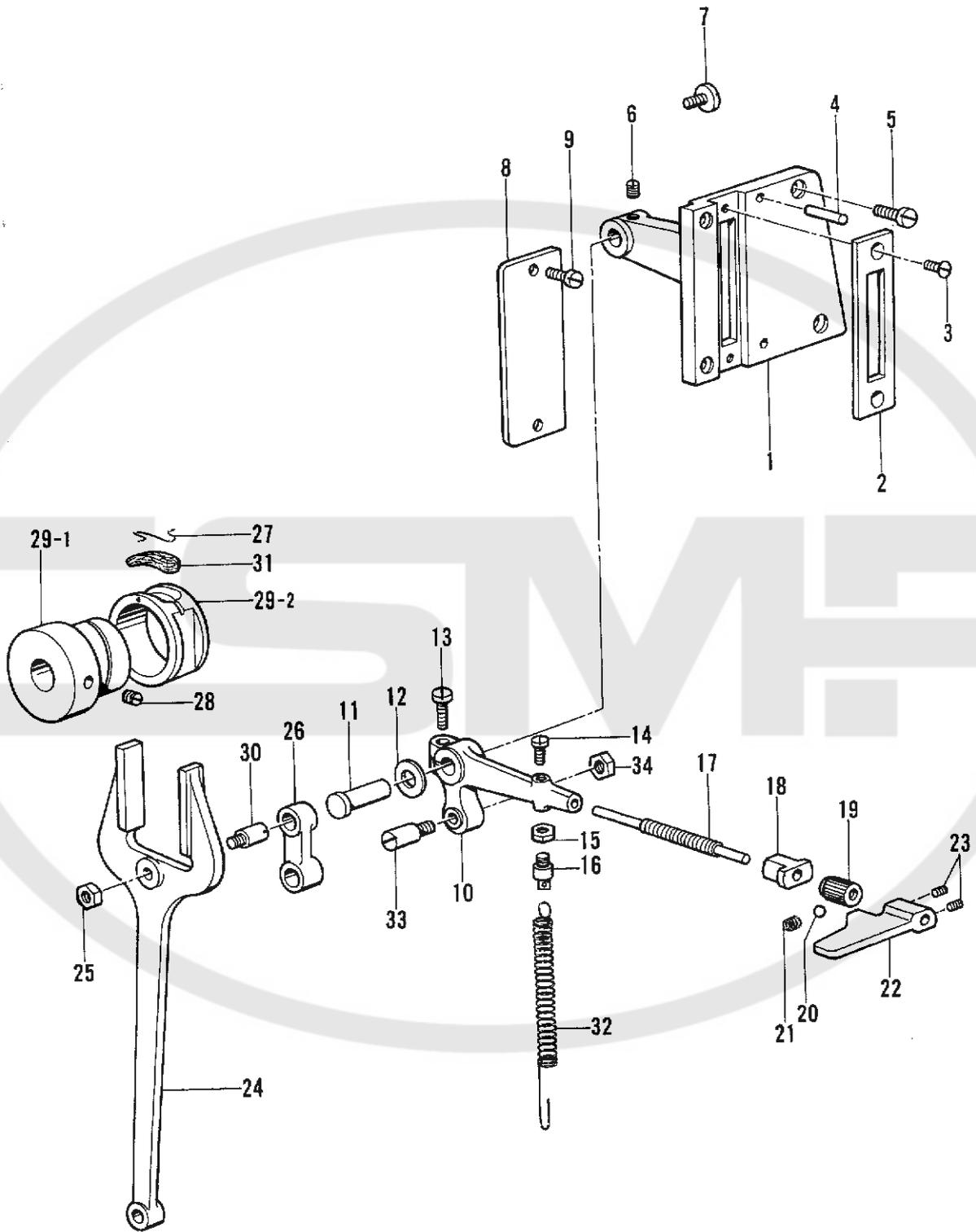
J. バック関係 / Reverse stitching mechanism/Rückwärtsnähvorrichtung/
