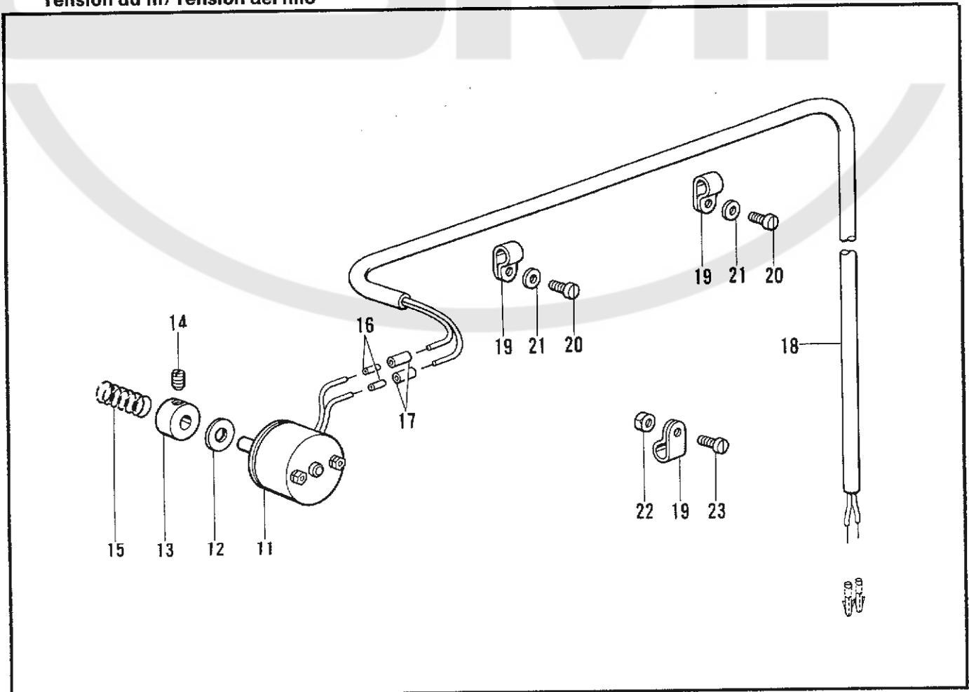
**K1. 糸調子関係 /Thread tension/Faderspannung/
