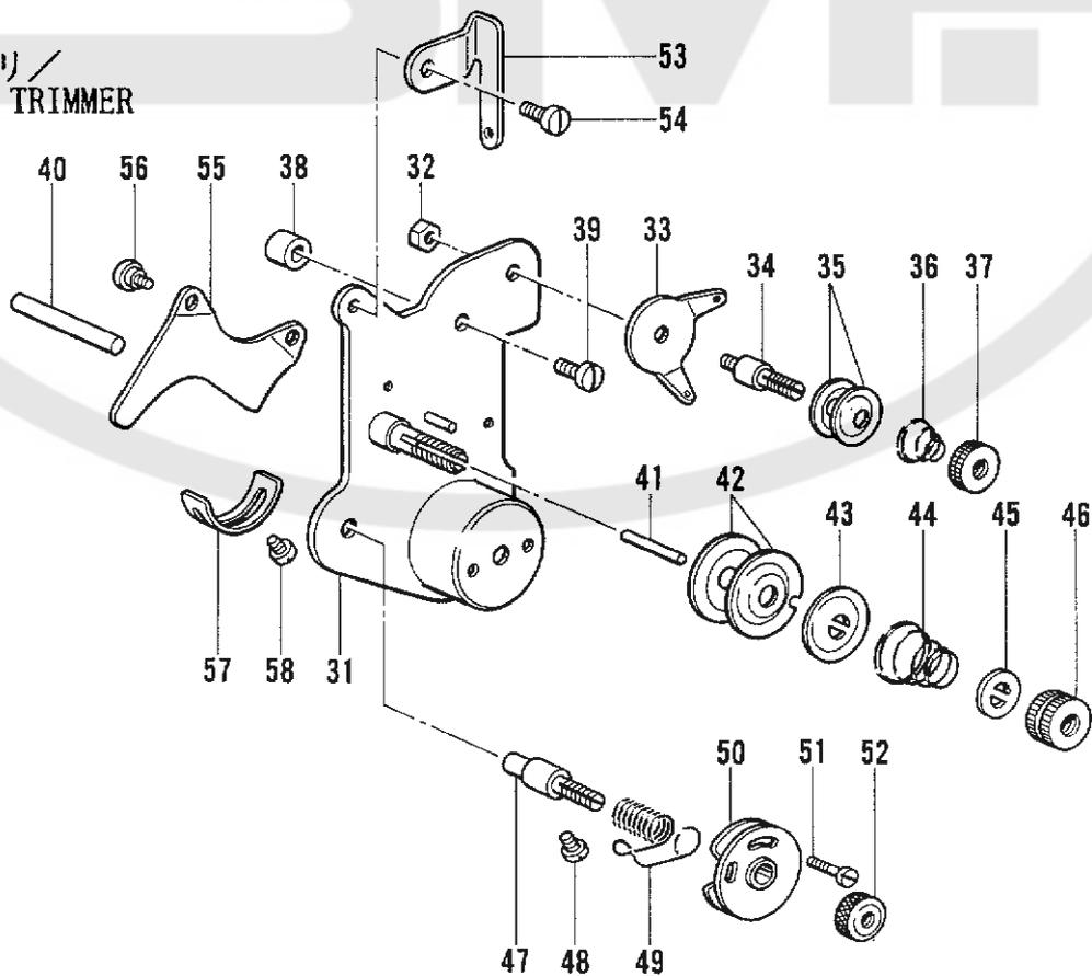
K3. 糸調子関係 /Thread tension/Faderspannung/
