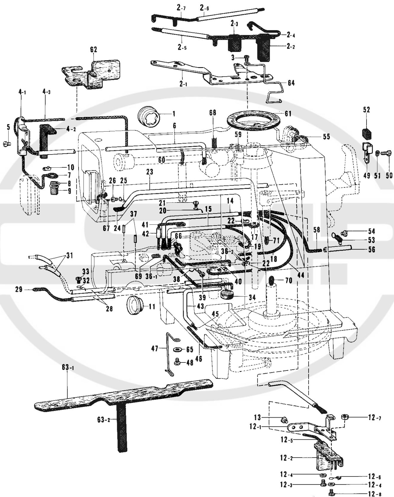
K. 給油・潤滑関係/Lubrication/Schmierung
