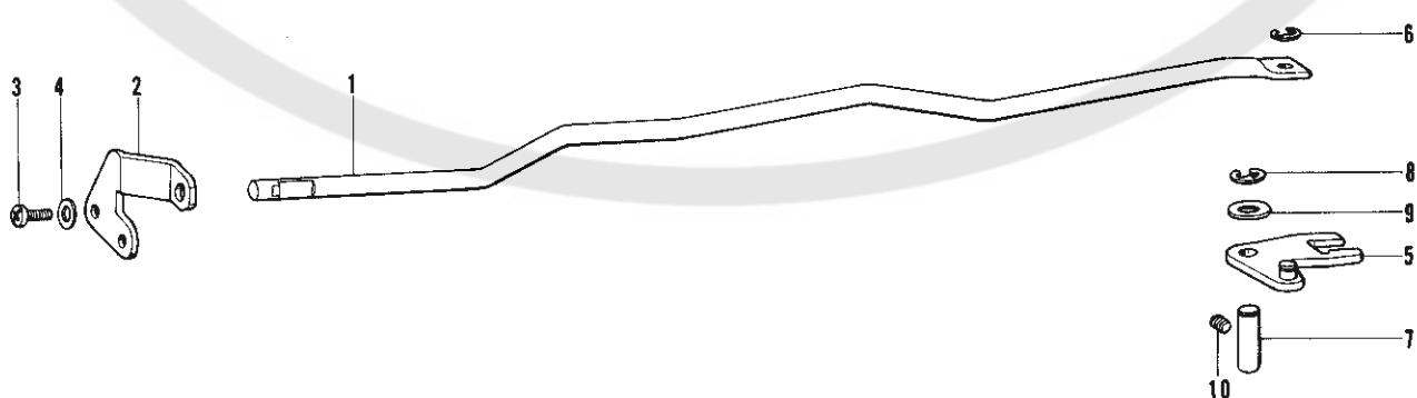
P. 糸拭イ関係 / Thread wiper mechanism / Fadenwischvorrichtung
