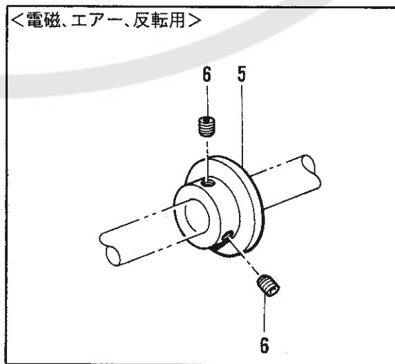
H. 糸巻関係 / Bobbin winder mechanism / Spuler / Mécanisme du bobineur / Mecanismo del devanador de la canilla
