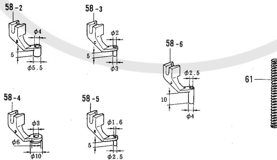
D2. 押工上部関係 / Presser foot lifter mechanism / Stoffhalterhebervorrichtung / Mécanisme de levage du pinceur / Mecanismo del levantador de mésula de trabajo
