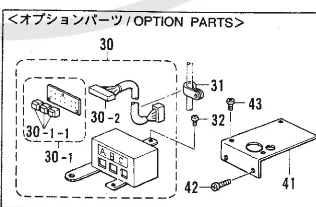
Q. 電装品関係 / Power supply equipment mechanism / Stromversorgung / Mécanisme de l'équipment en alimentation électrique / Mecanismo del equipo de alimentación de corriente
