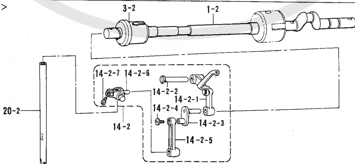
B. 上軸・針棒関係 / Upper shaft and needle bar mechanism / Obere Welle und Nadelstangenvorrichtung / Mécanisme de arbre supérieur et barra à aiguille / Mecanismo del eje superior y la barra de aguja
