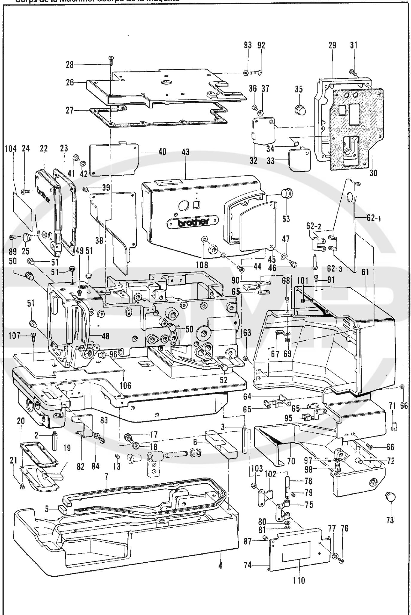
A. 主体関係/Machine body/Maschinengehäuse/
