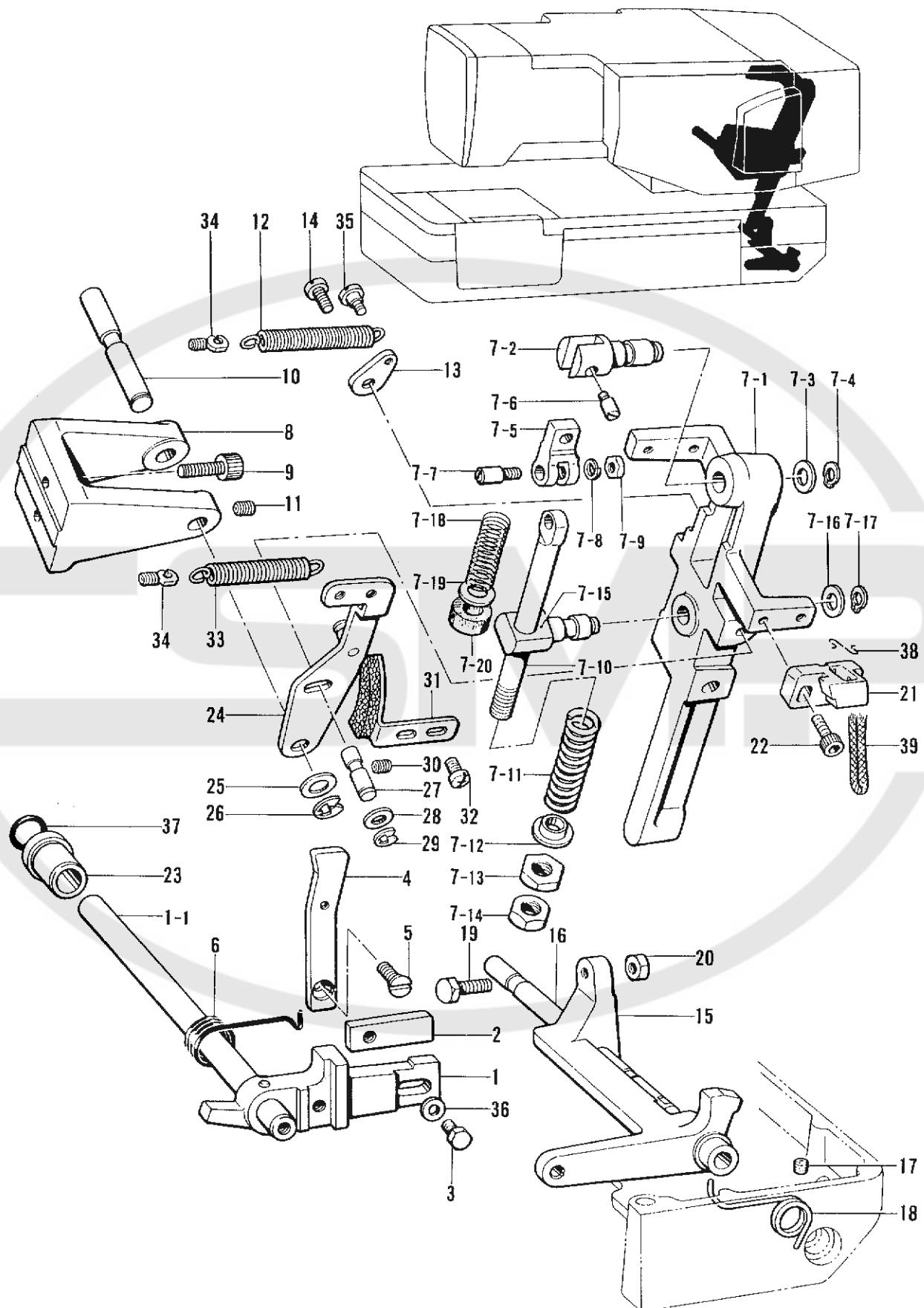
F. 停止関係/Clutch mechanism/Kupplungsvorrichtung/
