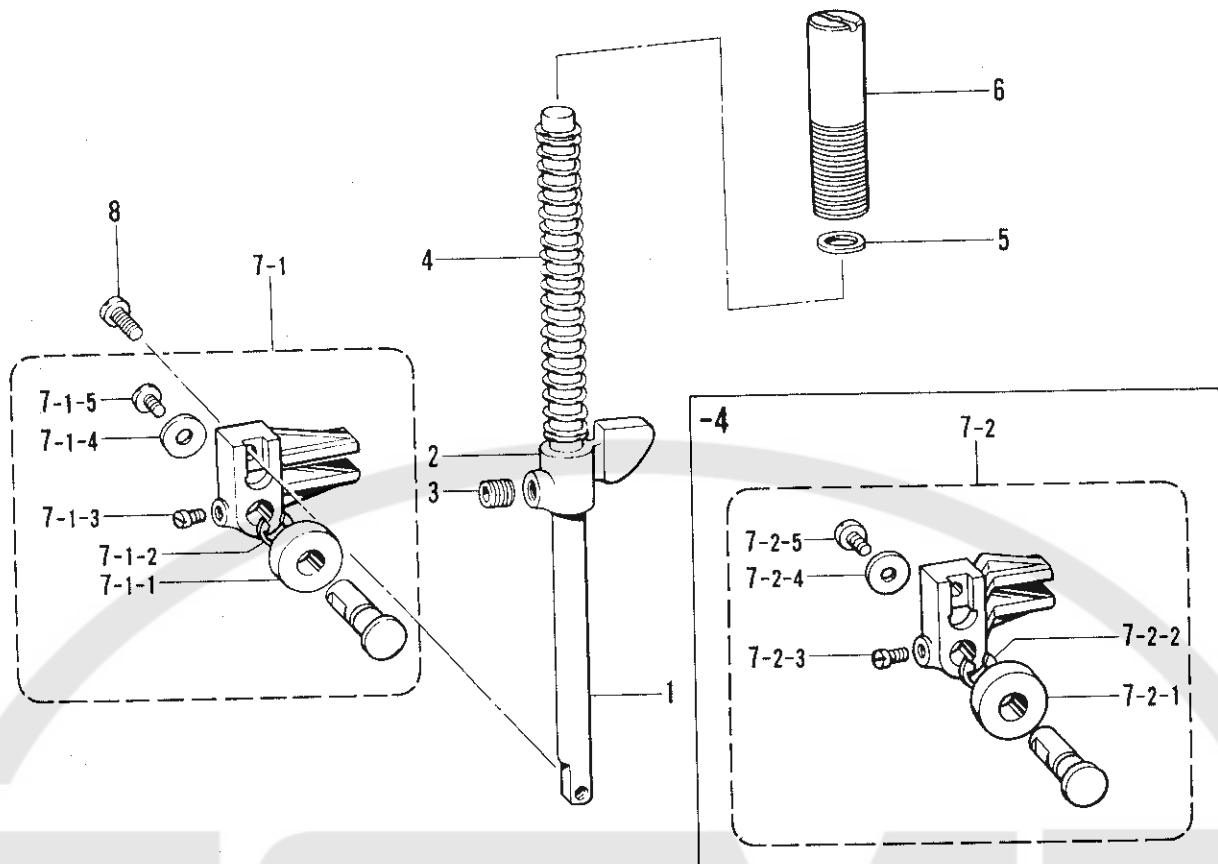
K. 押工関係 /Presser foot mechanism/Stoffdrückerfuß/
