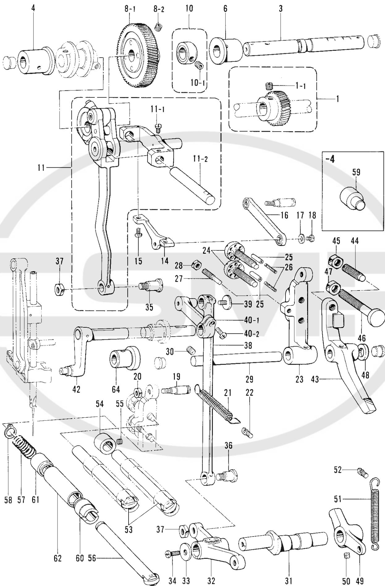
D. 針振関係 /Zigzag mechanism/Zickzackvorrichtung/
