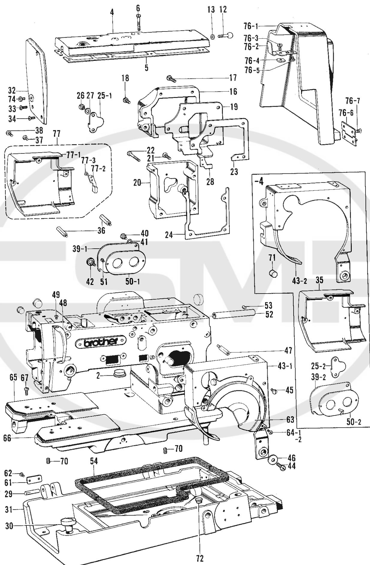
A. 主体関係 / Machine body/Maschinengehäuse/
