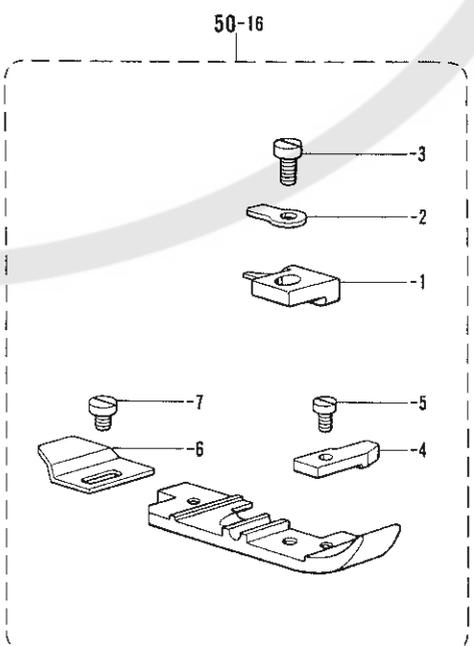
D. 押工関係/Presser foot mechanism/Stoffdrückerfuß/
