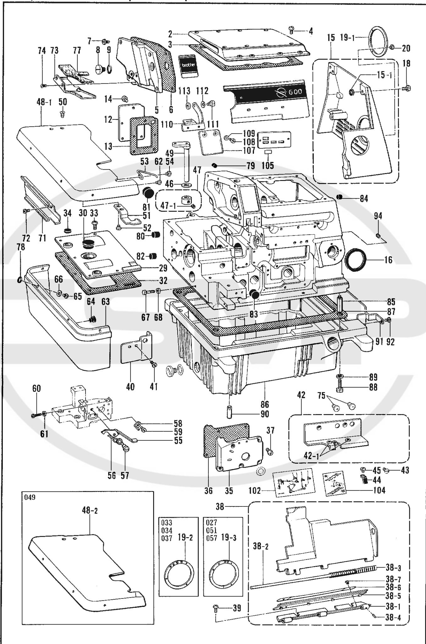
A. フレーム関係/Machine body/Maschinengehäuse/
