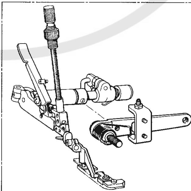
E. 押工関係/Presser foot mechanism/Stoffdrückerfuß/
