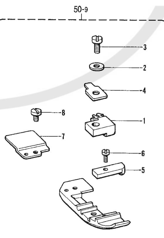
E. 押工関係/Presser foot mechanism/Stoffdrückerfuß/
