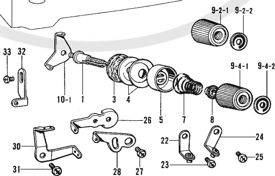
R. 糸調子関係/Thread tension/Faderspannung/Tension du fil/Tensión del hilo
