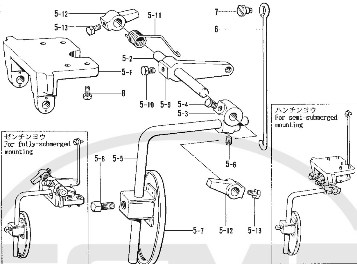
J. ラッパー関係 / Lapper mechanism / Falz-Mechanismus /
