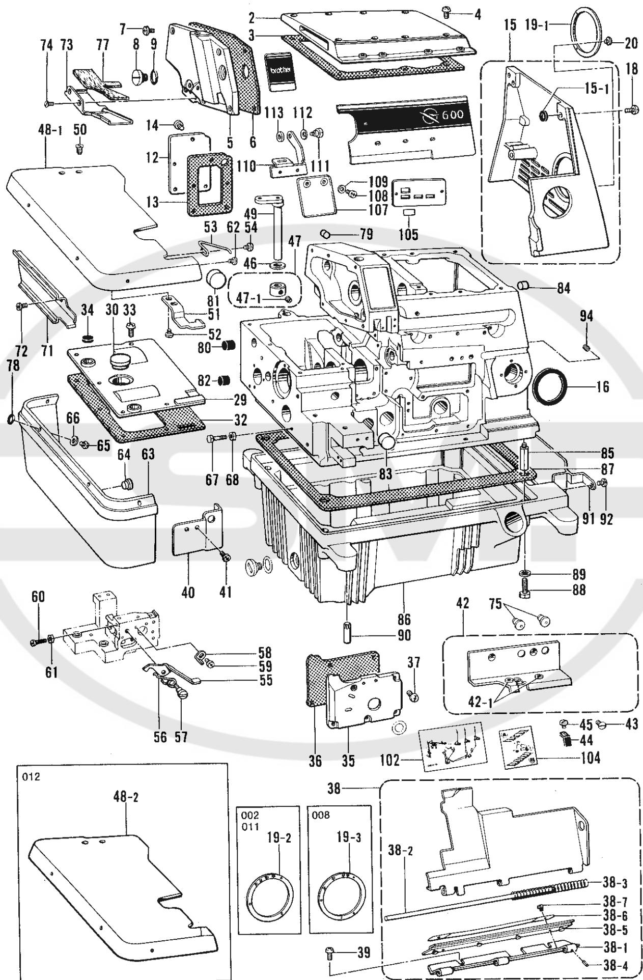
A. フレーム関係/Machine body/Maschinengehäuse/
