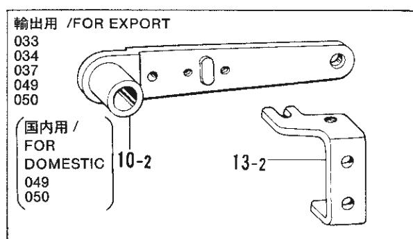
E. 押工関係/Presser foot mechanism/Stoffdrückerfuß/
