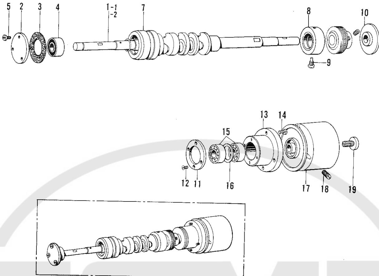
C. 針冷却装置/Needle cooler/Nadelkühlungsvorrichtung/
