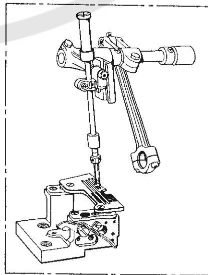
D. 針棒関係 / Needle bar mechanism / Nadelstangenvorrichtung /
