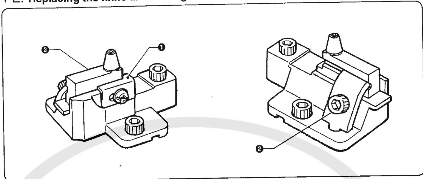
メスストップパ①とメスのすき間がないことを確認した後、穴付き締ねじ②をゆるめ、メスを取り外します。
