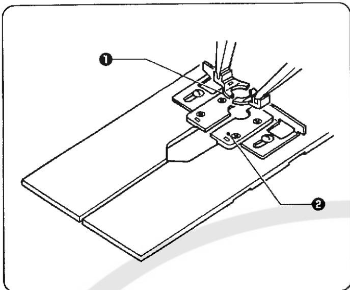
菊穴仕様専用の布押えプレートに交換します。
