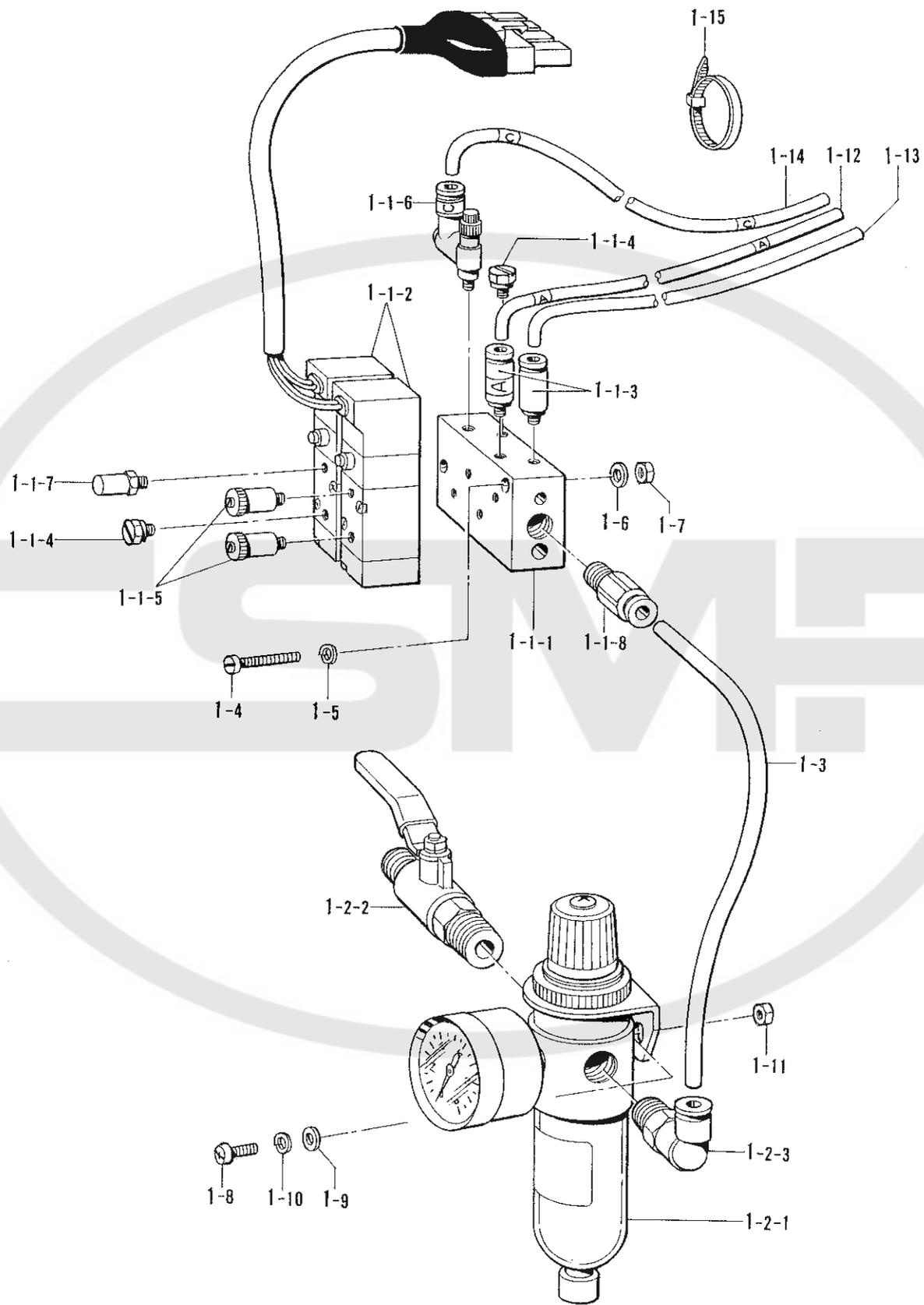
U. 空圧関係 / Air pressure mechanism / Luftdruck /
