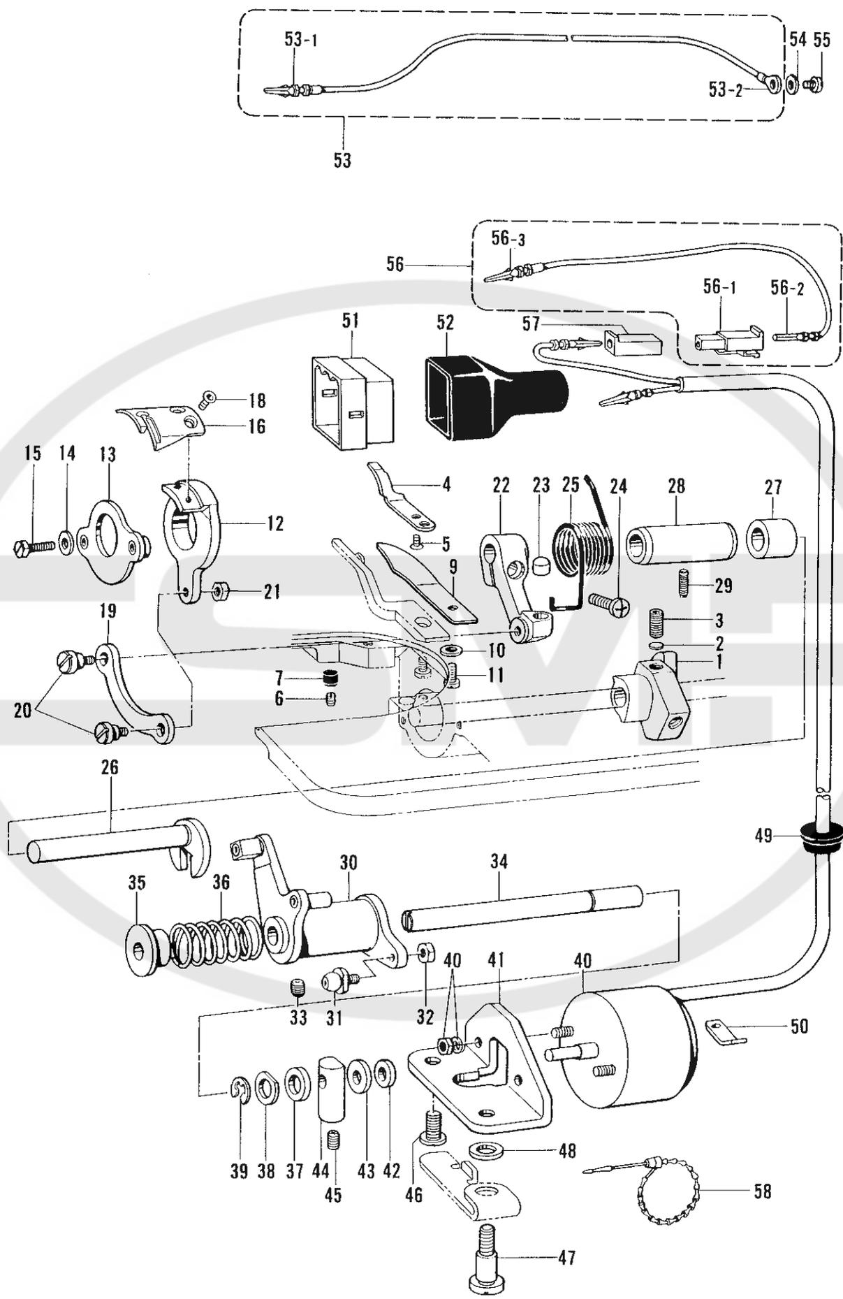
M. 糸切り関係 / Thread trimmer mechanism / Fadenabschneidevorrichtung /
