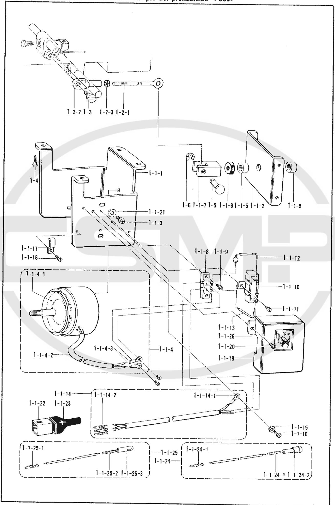
Y1. 電磁押工上ゲ関係 <-900>/Presser foot lifting solenoid set <-900>/Solenoidsatz für die Anhebung de Stoffdrückerfußes <-900>/Jeu de solénoïde du releveur du pied presseur <-900>/ Conjunto solenoide del levantador del pie del prensatelas <-900>
