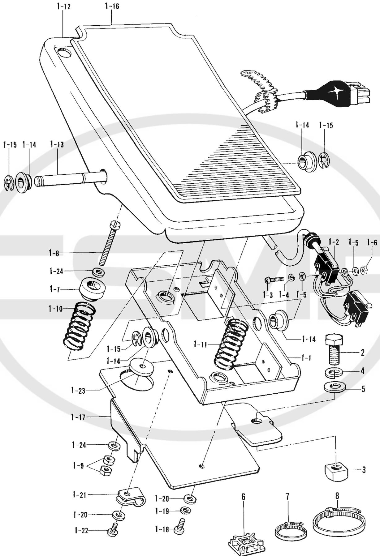
X. 踏ミ板関係 / Treadle mechanism / Fubbetätigung /
