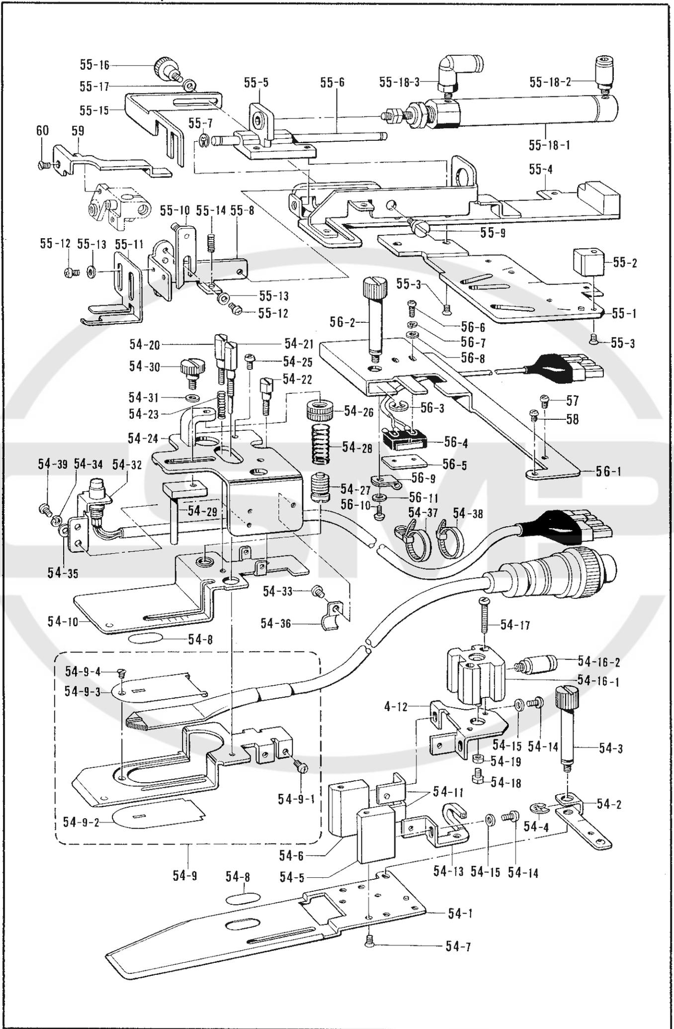
W2. 布制御関係 / Cloth control system mechanism / Stoffführungsrichtung /
