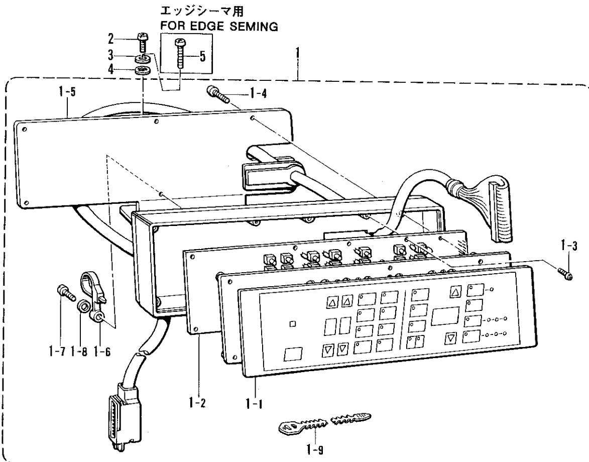
S. 逆転スイッチ関係 / Quick reverse switch mechanism / Umkehrschalter /
