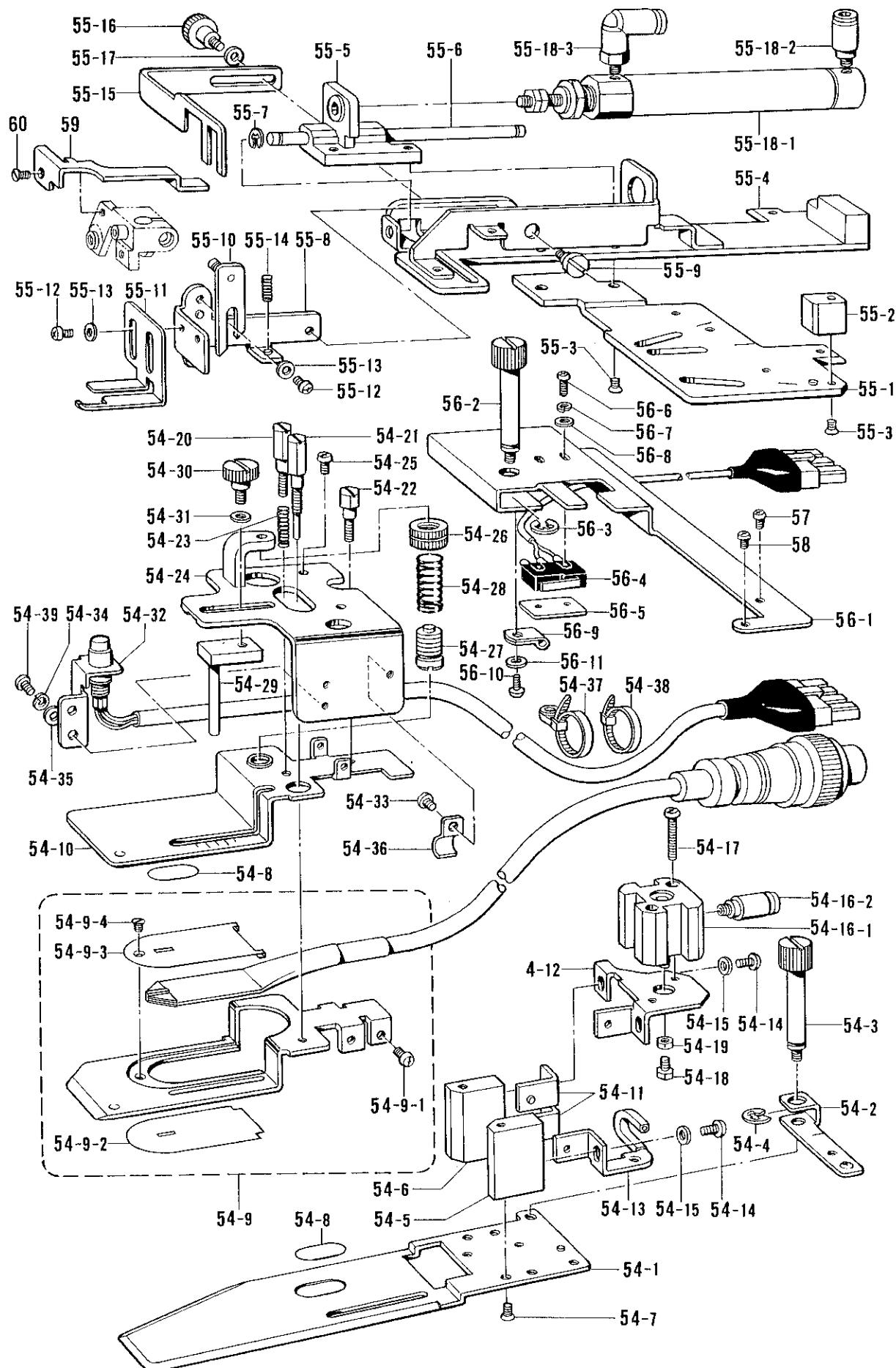
W2. 布制御関係 / Cloth control system mechanism / Stoffführungs vorrichtung /
