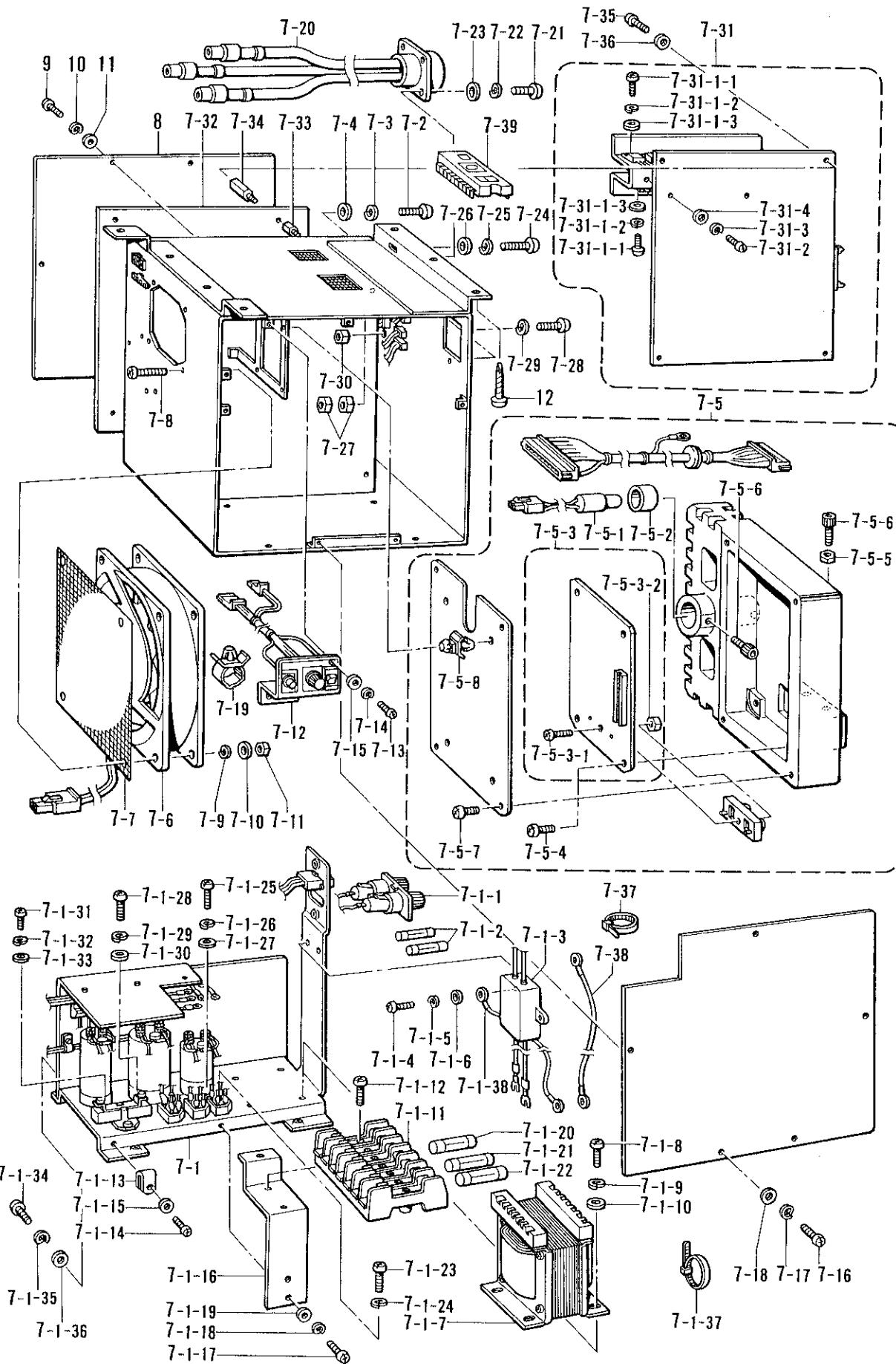
T2. コントロールボックス関係 / Control box mechanism / Schaltkasten /
