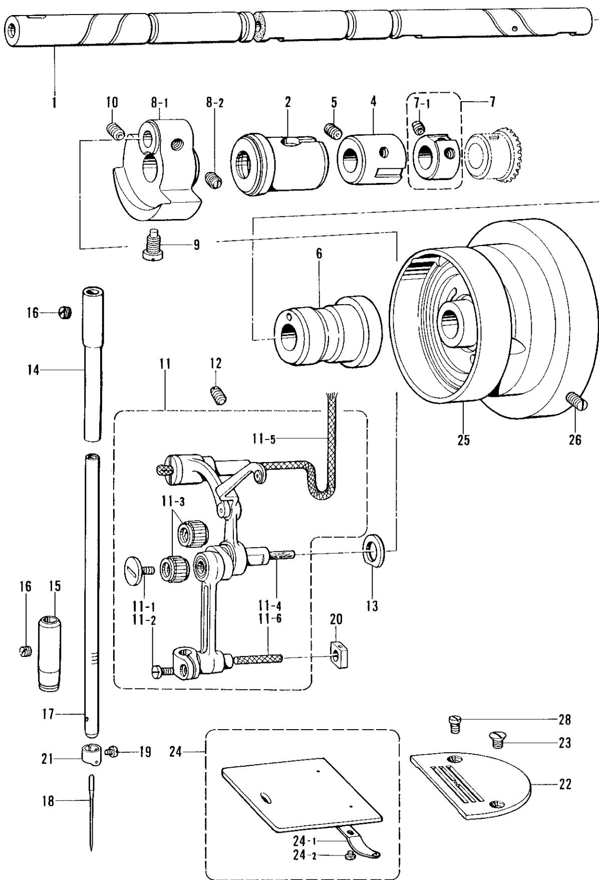
C. 針棒天ビン関係 / Needle bar and thread take-up mechanism / Nadelstangen-und Fadenabnahmeverrichtung / Mécanisme de la barre à aiguille et releveur de fil / Mecanismo de la barra de aguja y tirahilos
