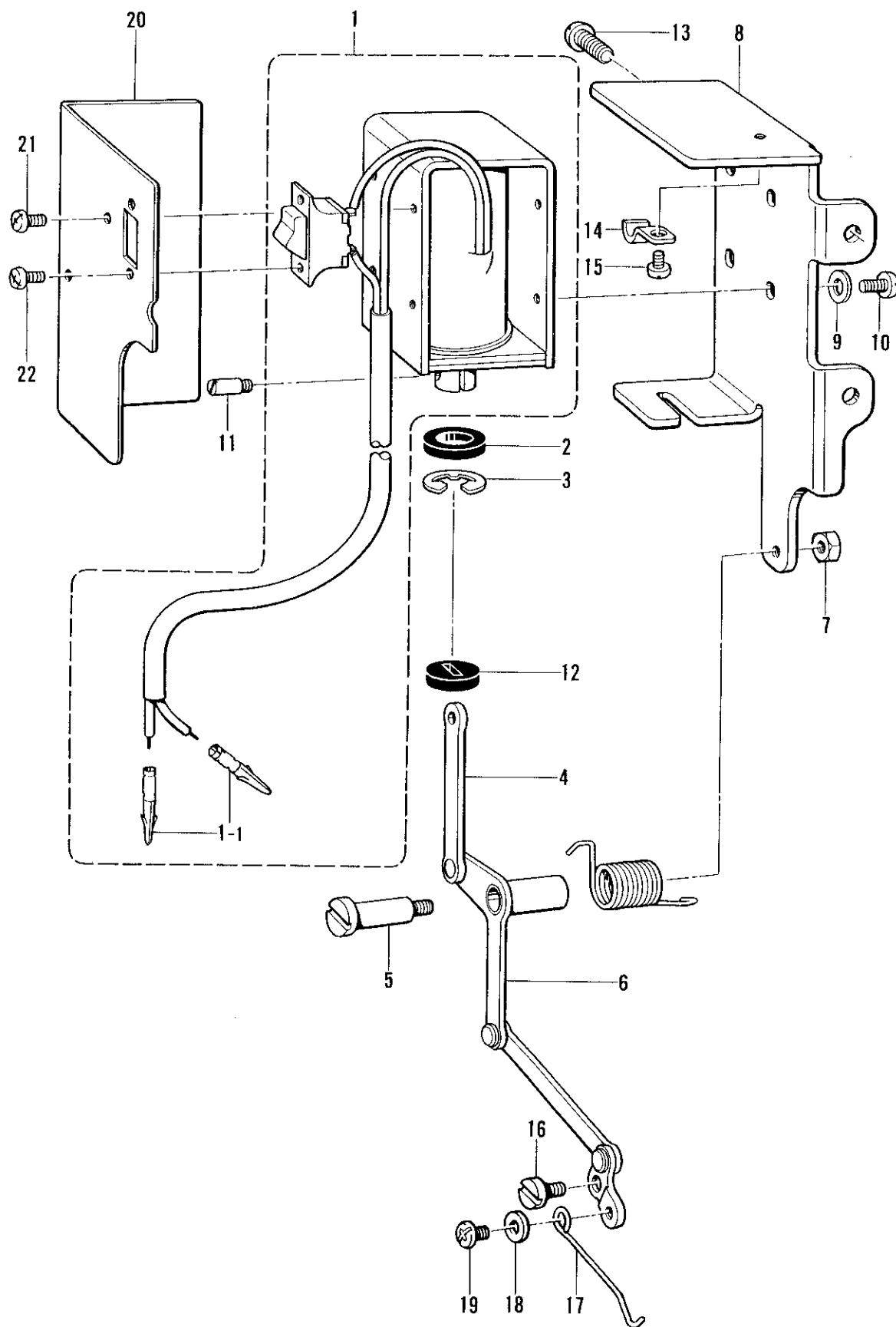
N. 糸扱イ関係 / Thread wiper mechanism / Fadenspannvorrichtung /
