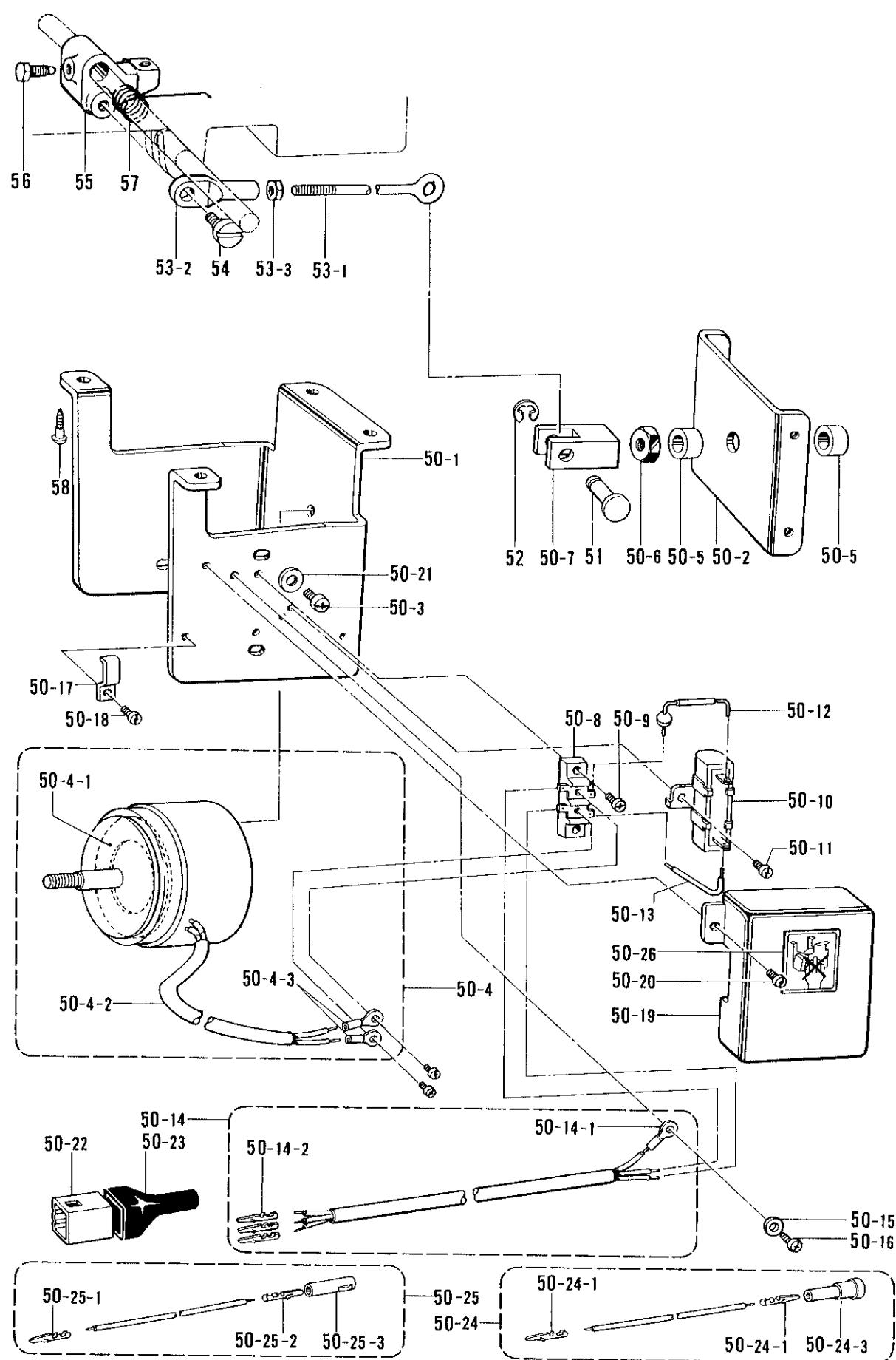
F. 押エ上部関係 <-900> / Presser foot lifter mechanism <-900> / Stoffhalterhebervorrichtung <-900> /
