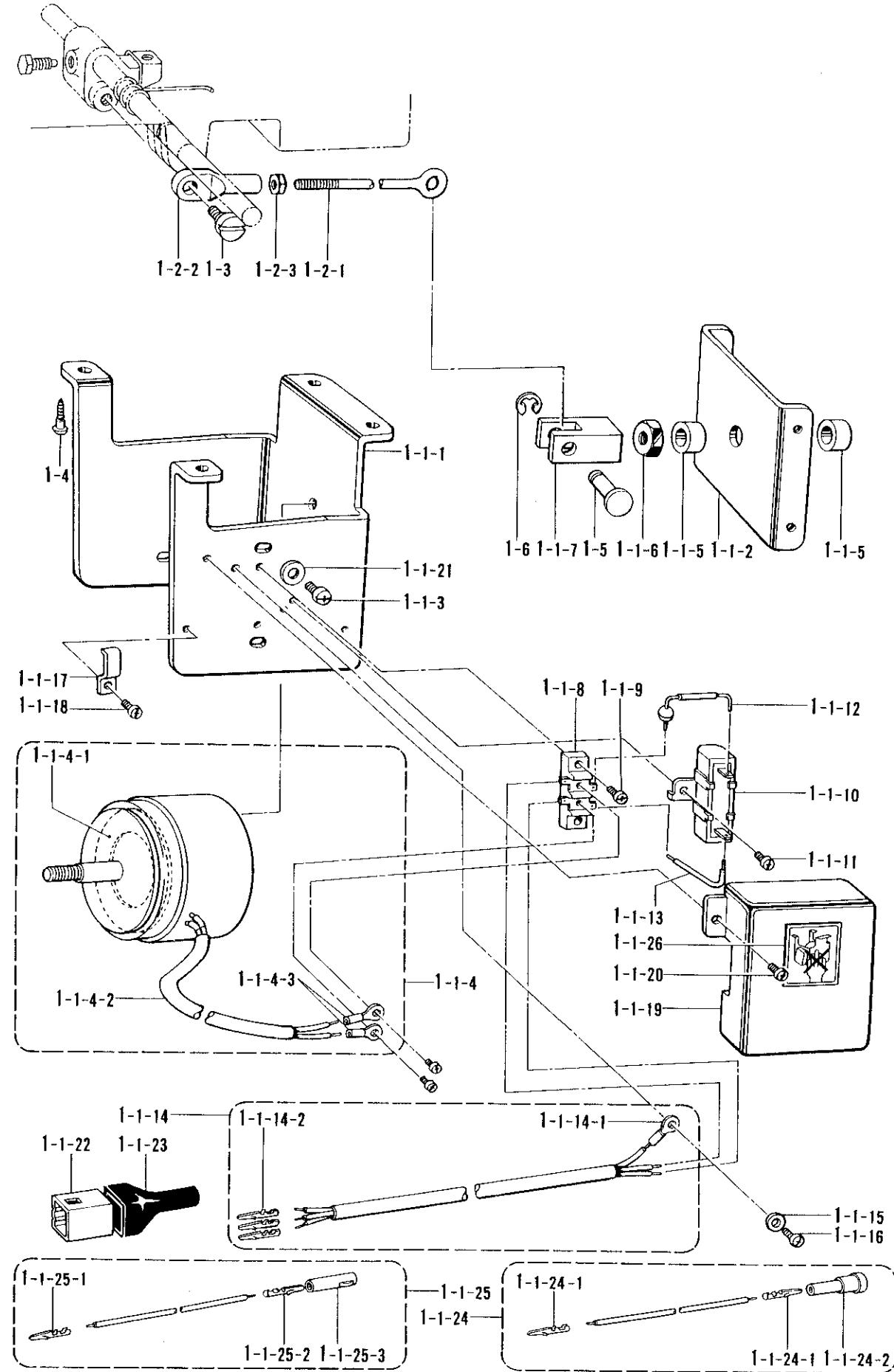
Y1. 電磁抑工上ヶ関係 <-900> / Presser foot lifting solenoid set <-900> / Solenoidsatz für die Anhebung de Stoffdrückerfußes <-900> / Jeu de solénoïde du releveur du pied presseur <-900> / Conjunto solenoide del levantador del pie del prensatelas <-900>
