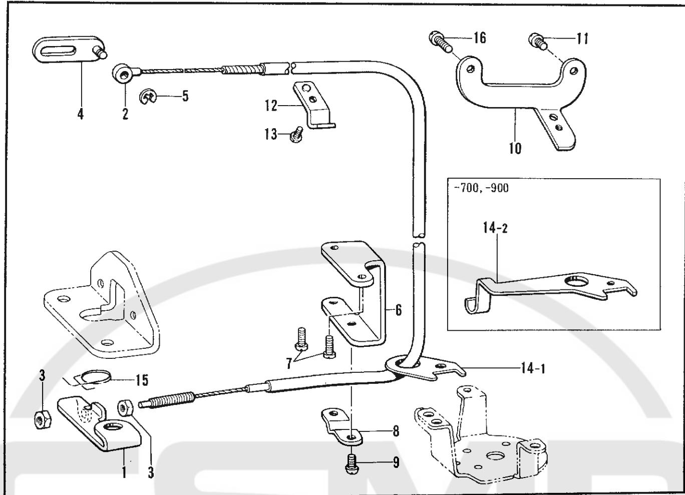
Q. 糸拭い関係 <B772> / Thread wiper mechanism <B772> / Fadenwischvorrichtung <B772> /
