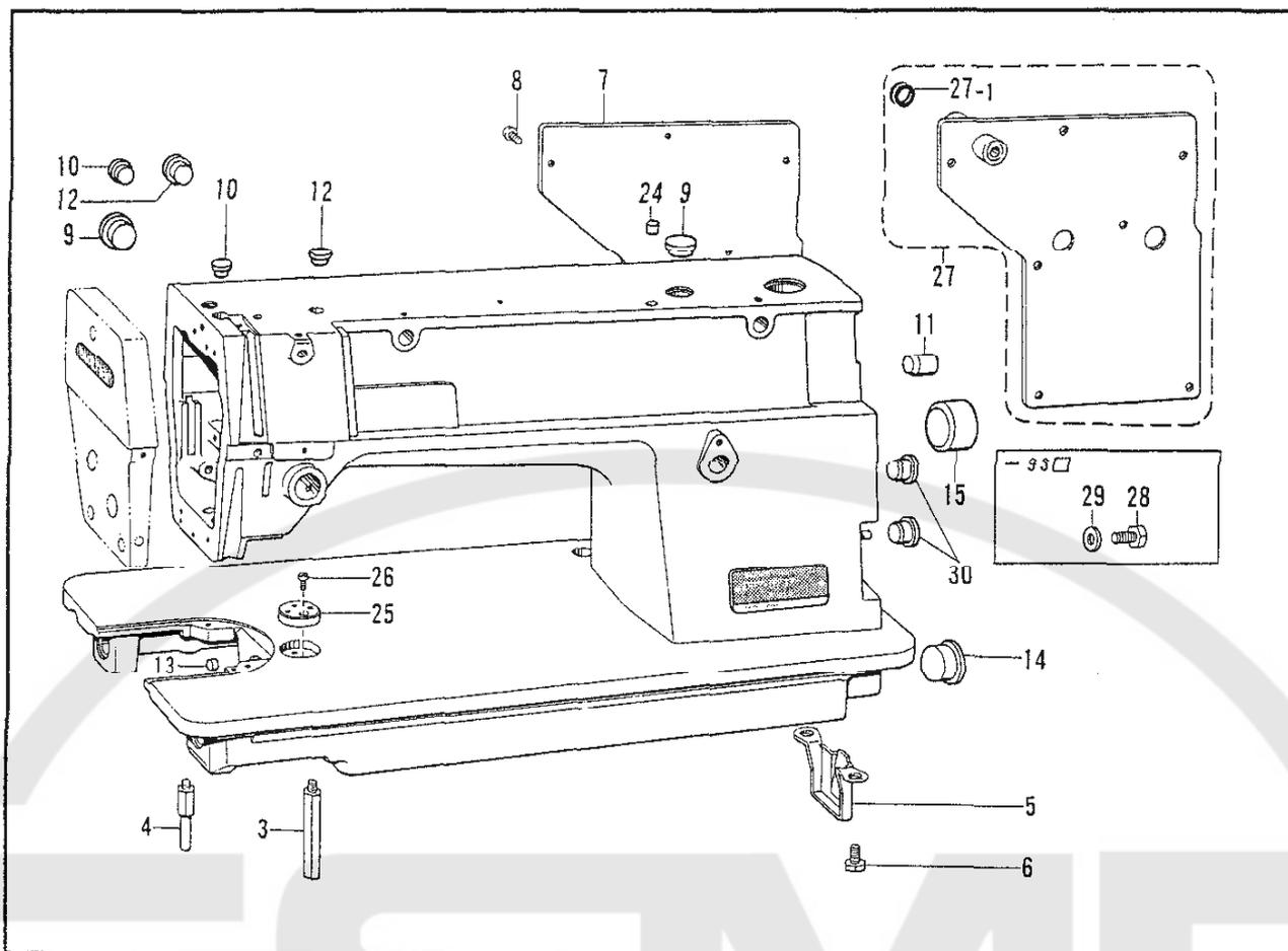
B. ヒザ上げ関係 / Knee lifter mechanism / Kniehebel / Mécanisme de genouillère / Mecanismo de levantador de rodilla
