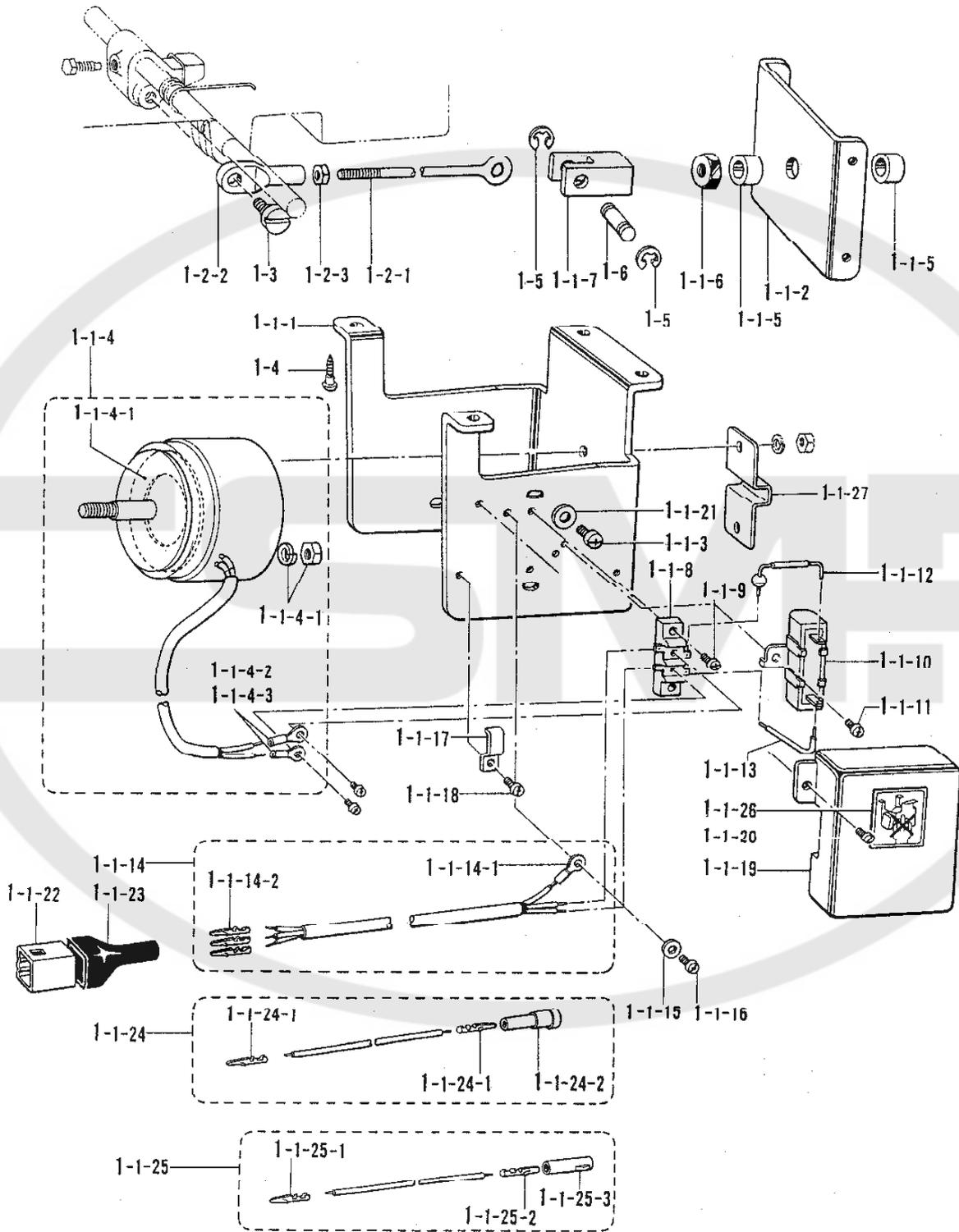
X1. 電磁押上げセット/Presser foot lifting solenoid set/Solenoidsatz für die Anhebung des Storrückerttises/
