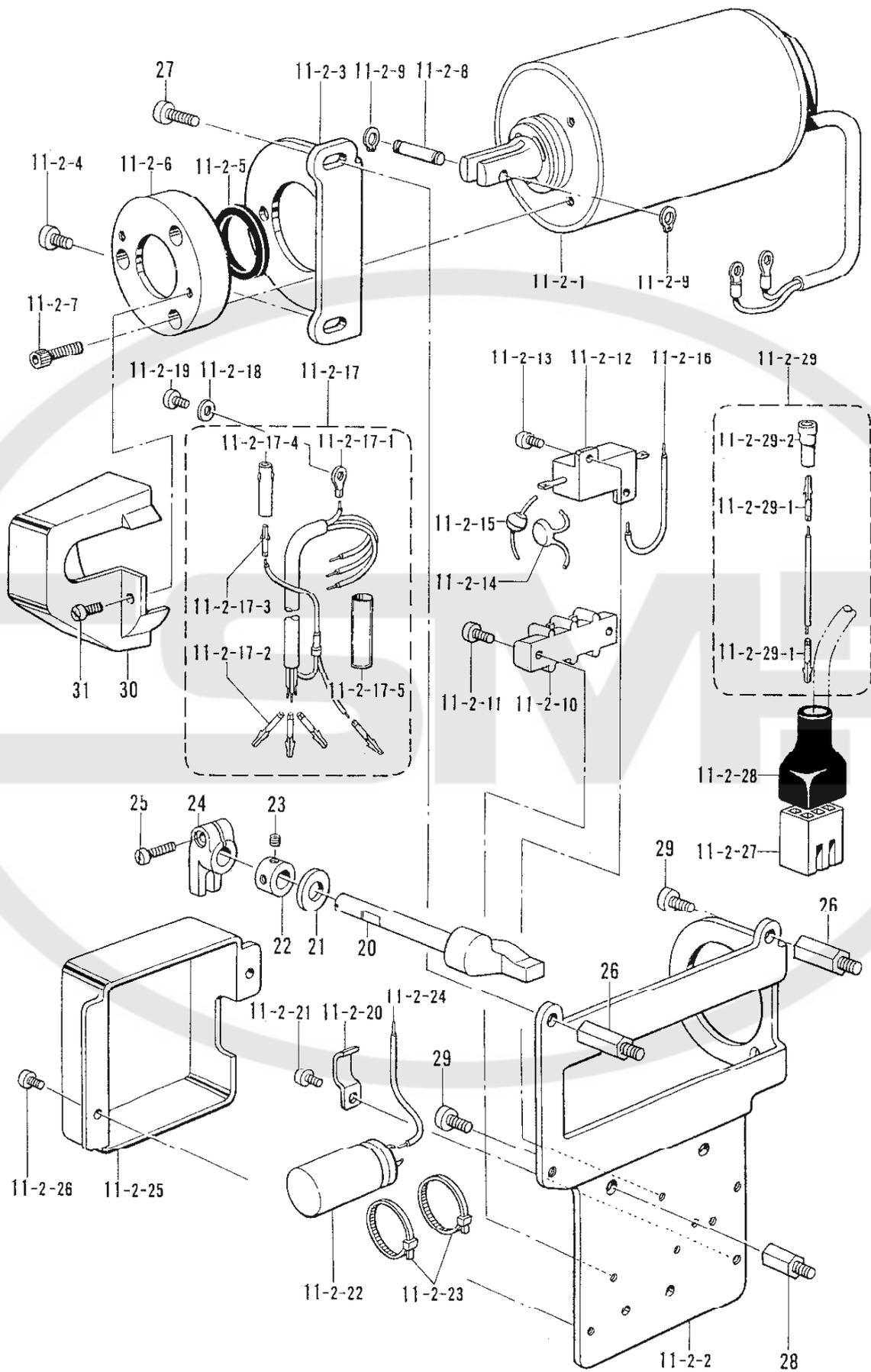
F2. 押工上げ関係 / Work clamp lifter mechanism / Stoffhalterhebevorrichtung /
