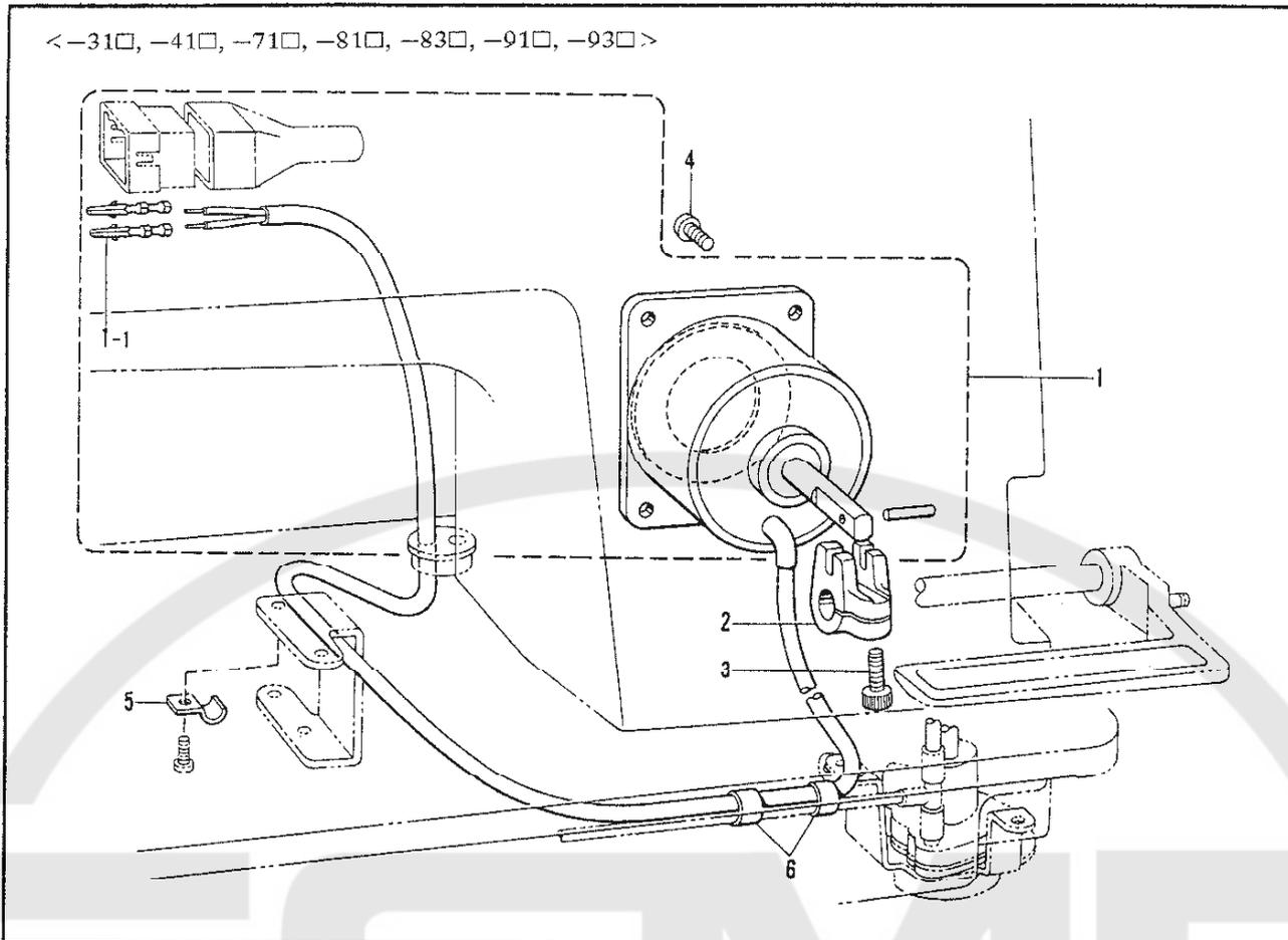
M. 糸ユルメ関係/Tension release mechanism/Spannungsverminderungsvorrichtung/
