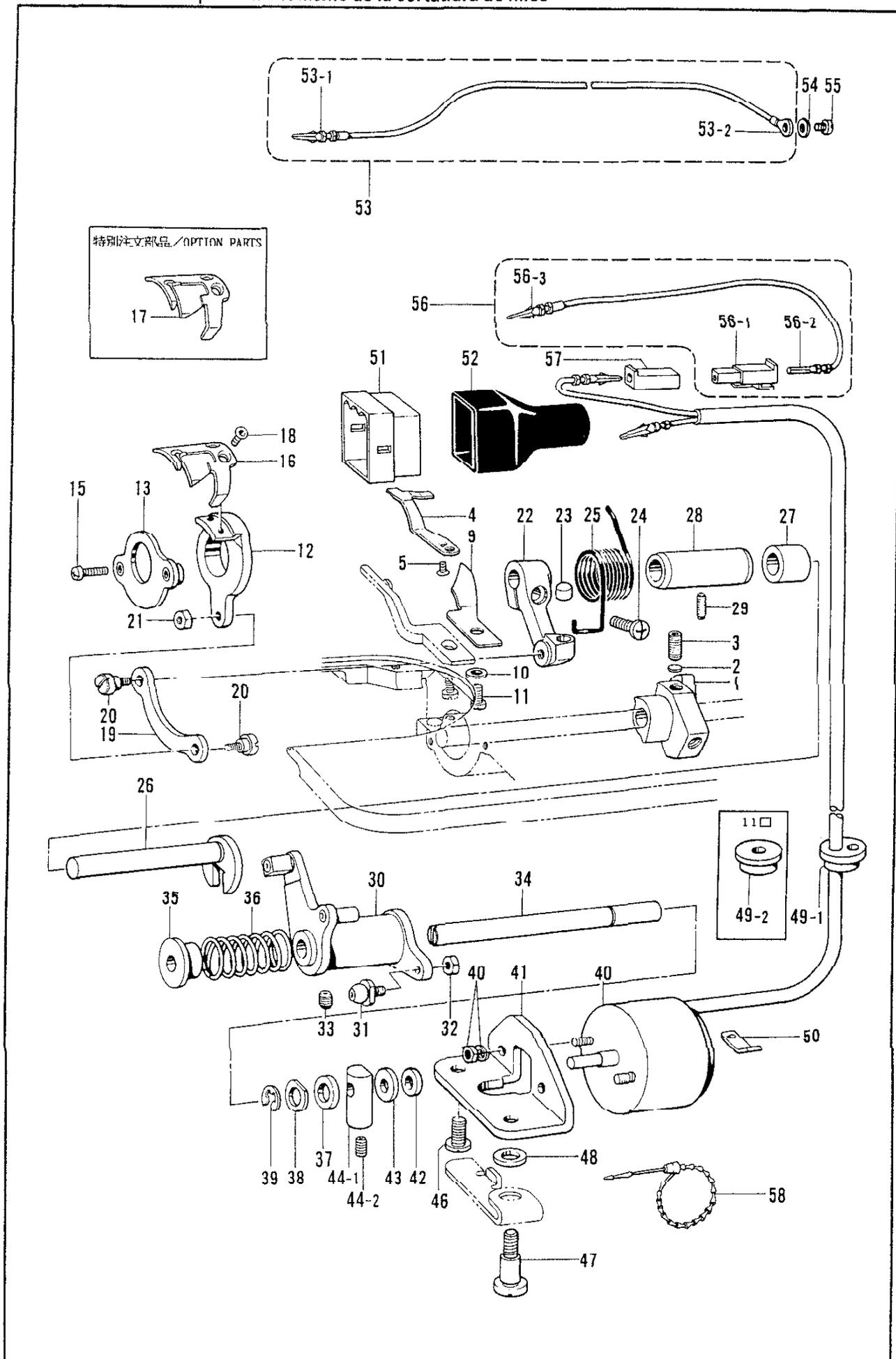
K. 糸切り関係/Thread trimmer mechanism/Fadenabschneidevorrichtung/
