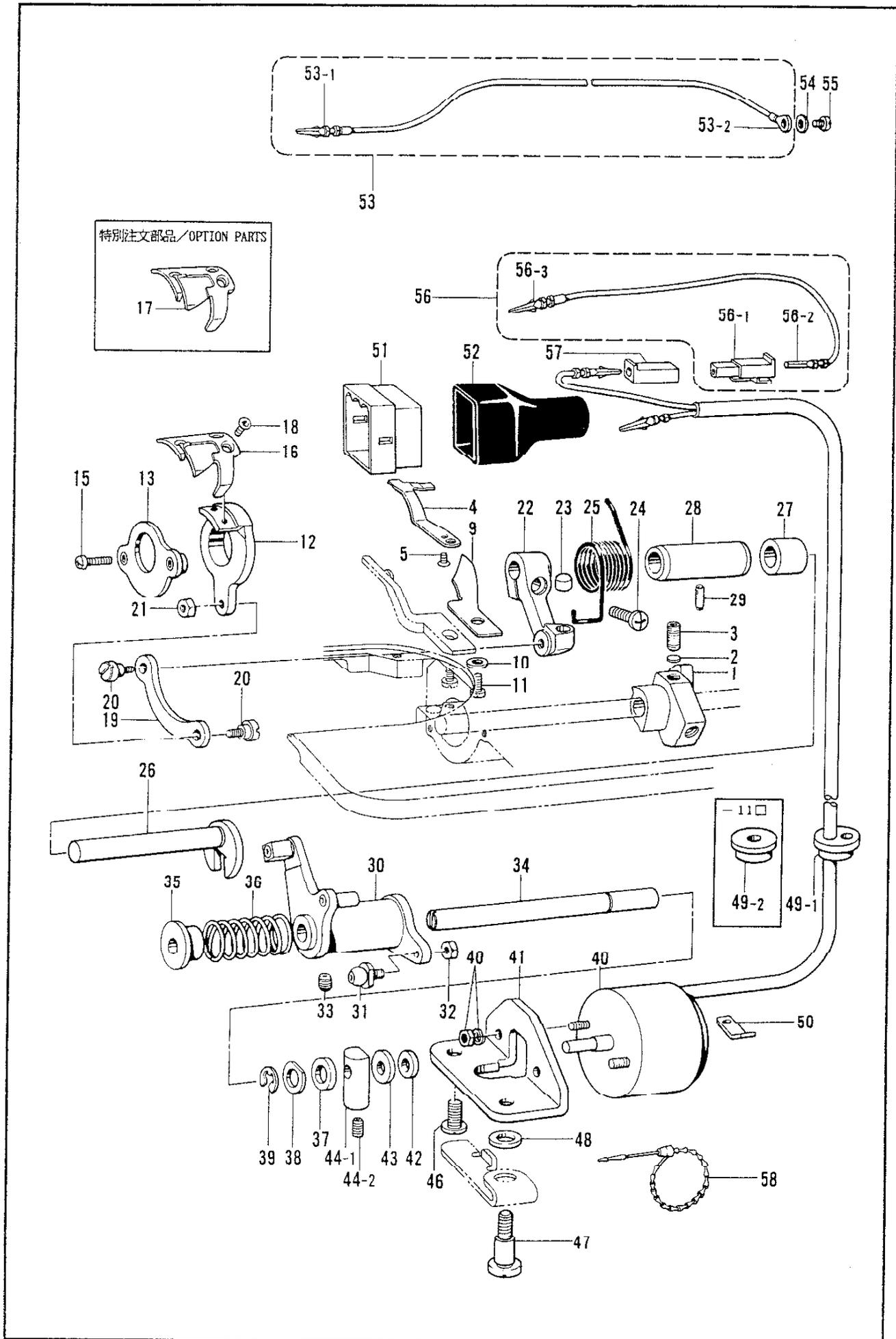
K. 糸切り関係/Thread trimmer mechanism/Fadenabschneidevorrichtung/
