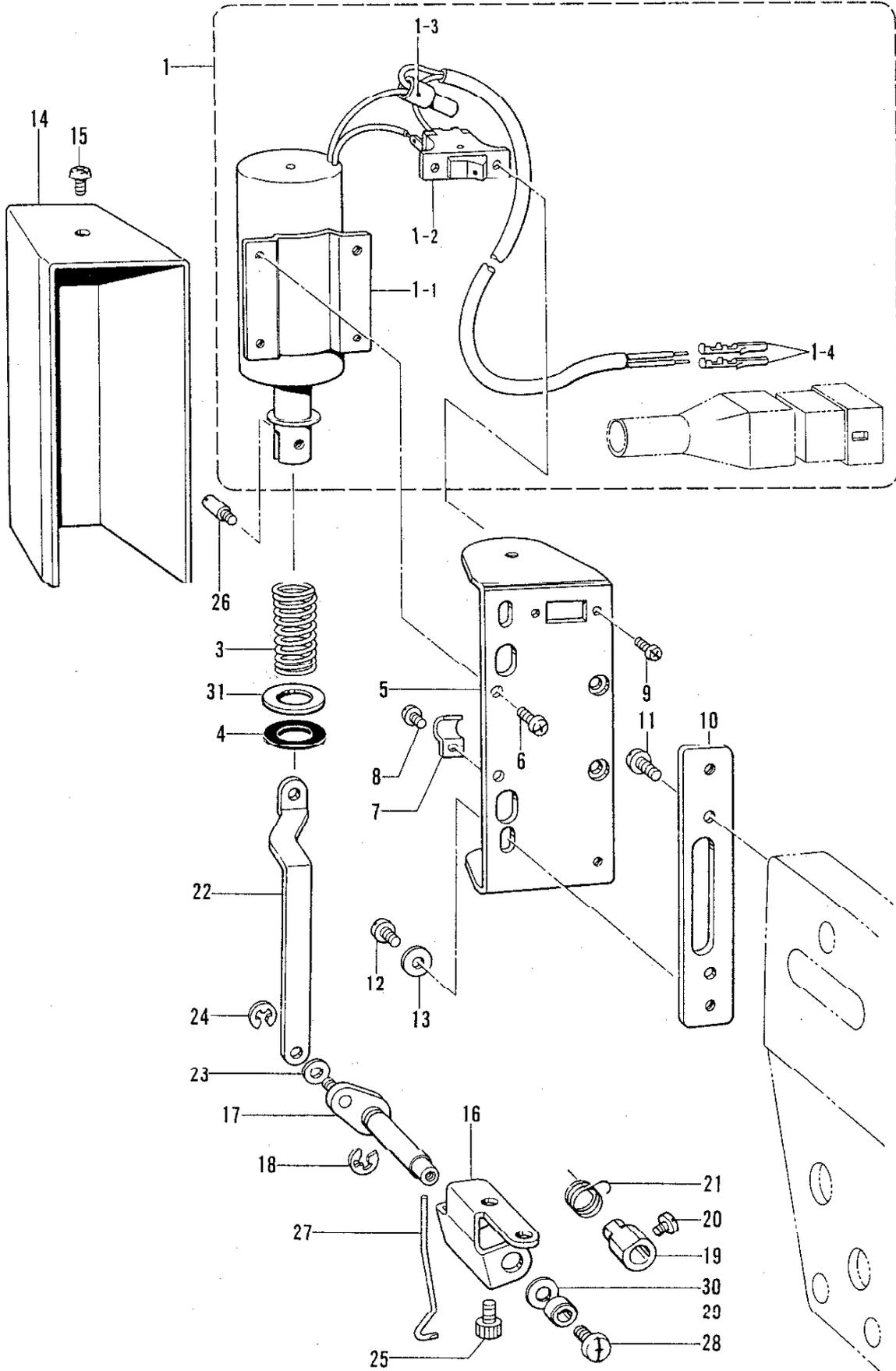
N. 糸払イ関係/Thread wiper mechanism/Fadenwischvorrichtung/
