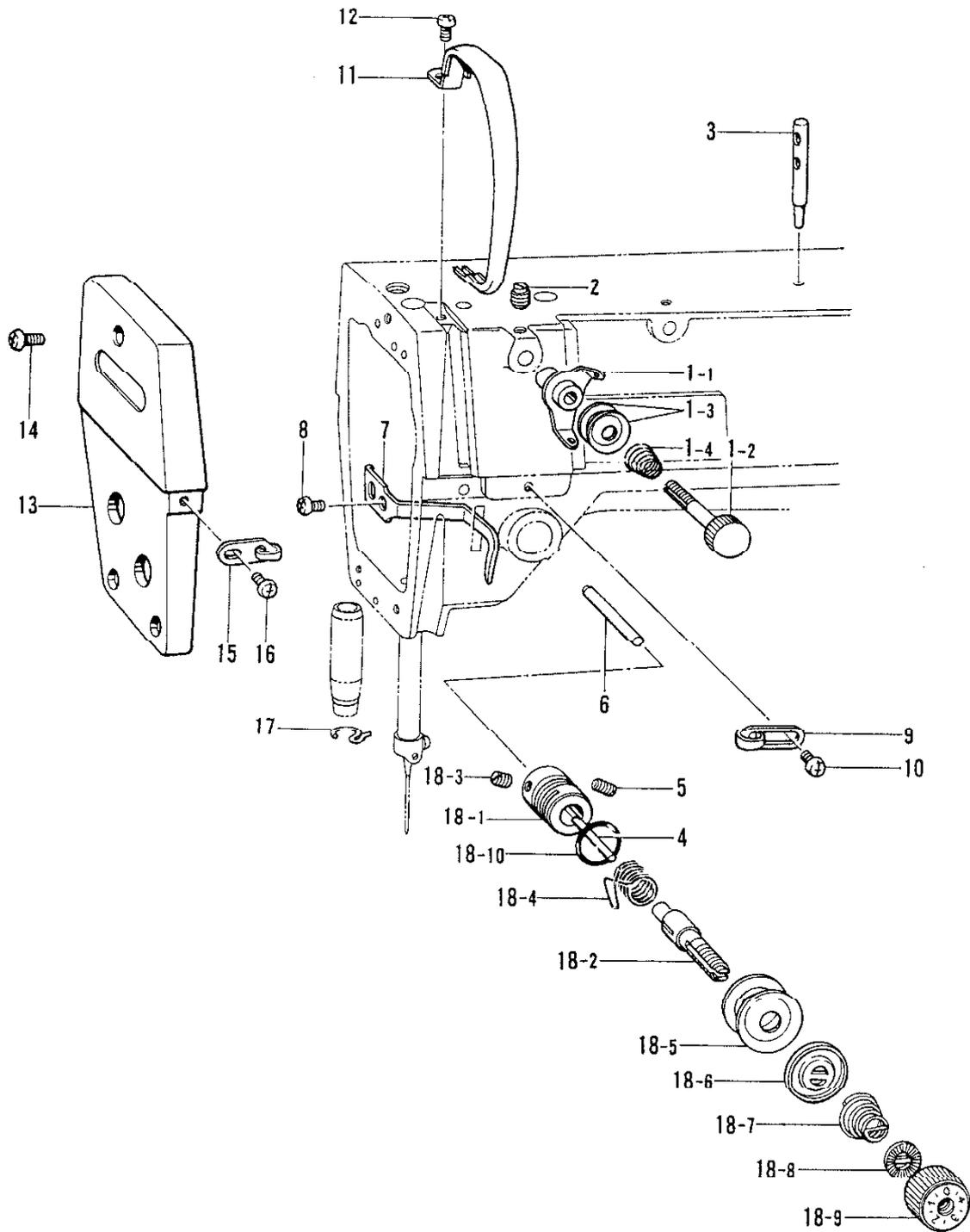
J. 糸通シ関係 / Threading mechanism / Fadenführungsrichtung /
