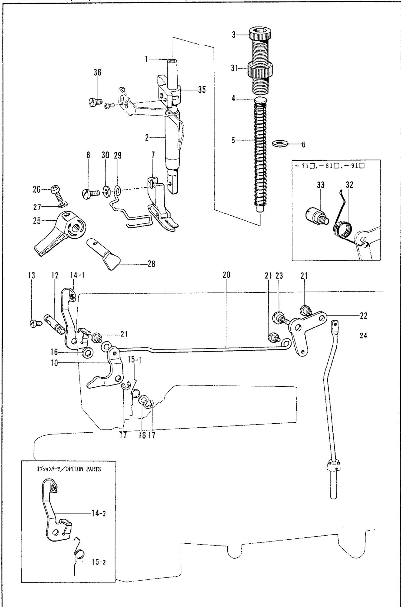
D. 押工関係/Presser foot mechanism/Stoffdrückerfuß/
