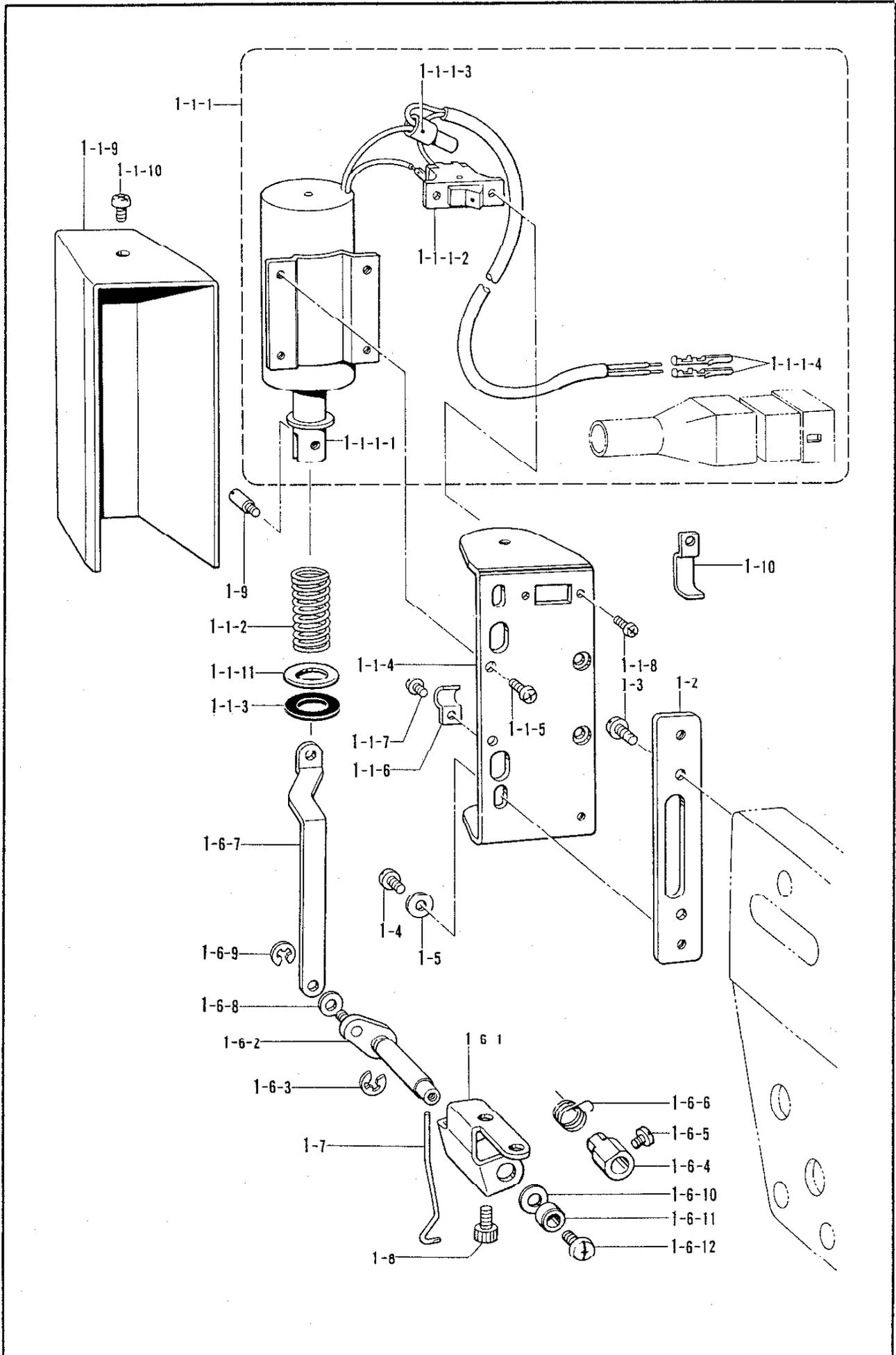
W. 糸払イセット/Thread wiper set/Fedenspannvorrichtung/
