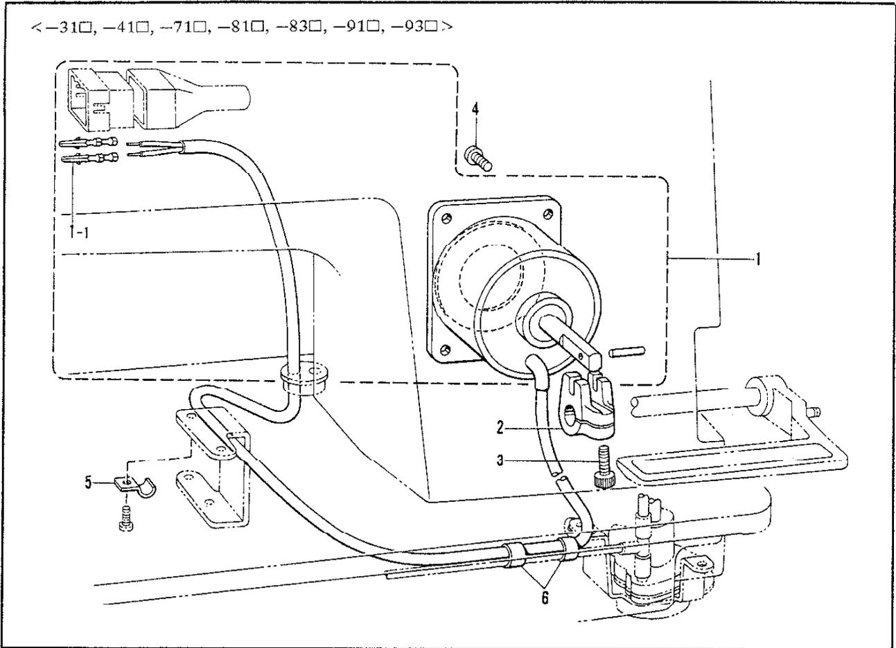
M. 糸ユルメ関係/Tension release mechanism/Spannungsverminderungsvorrichtung/
