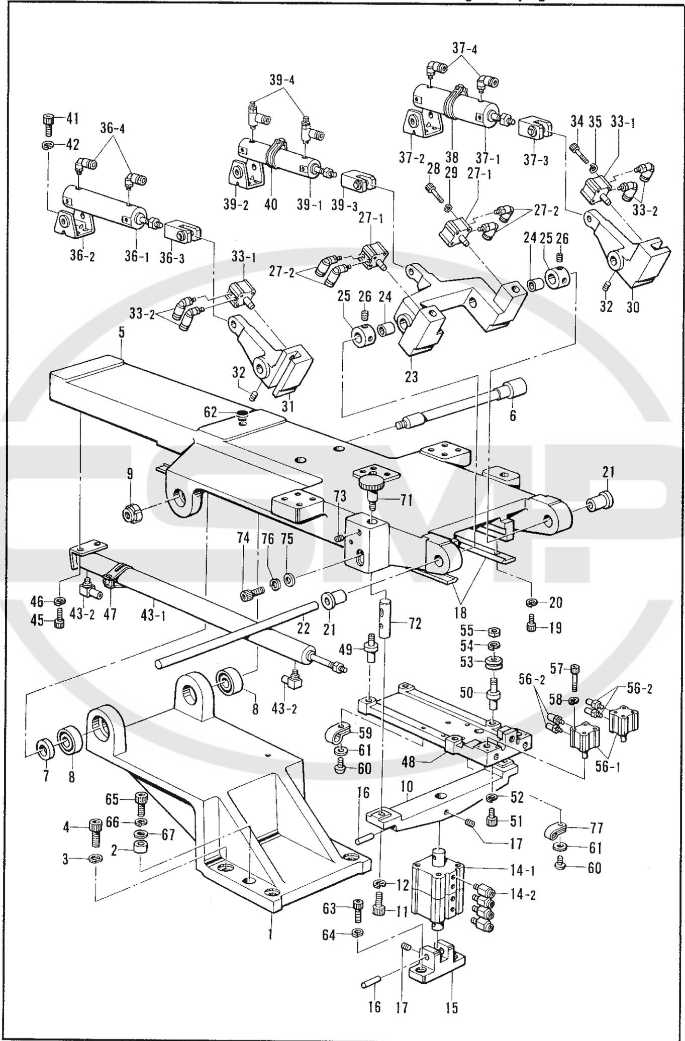
U. 折曲ゲ土台関係/Folding margin base mechanism/Faltungsvorrichtungsgundplatte/
