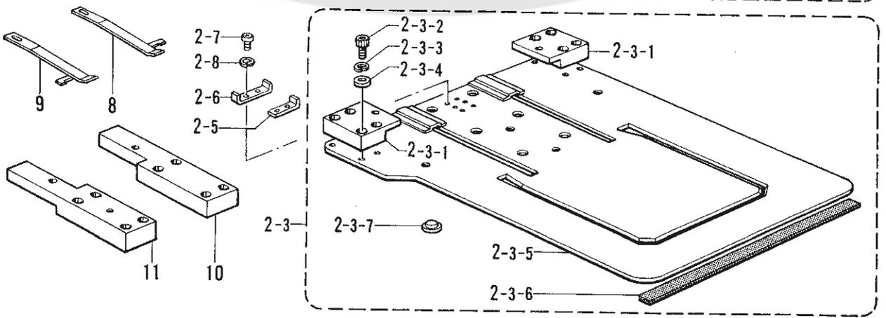
T. 折曲ゲ関係 (特別注文部品)/Folding margin mechanism (Option parts)/Faltungsvorrichtung (Sonderzubehör)/
