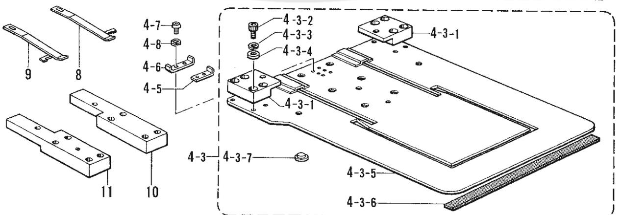
T. 折曲ゲ関係 (特別注文部品)/Folding margin mechanism (Option parts)/Faltungsvorrichtung (Sonderzubehör)/
