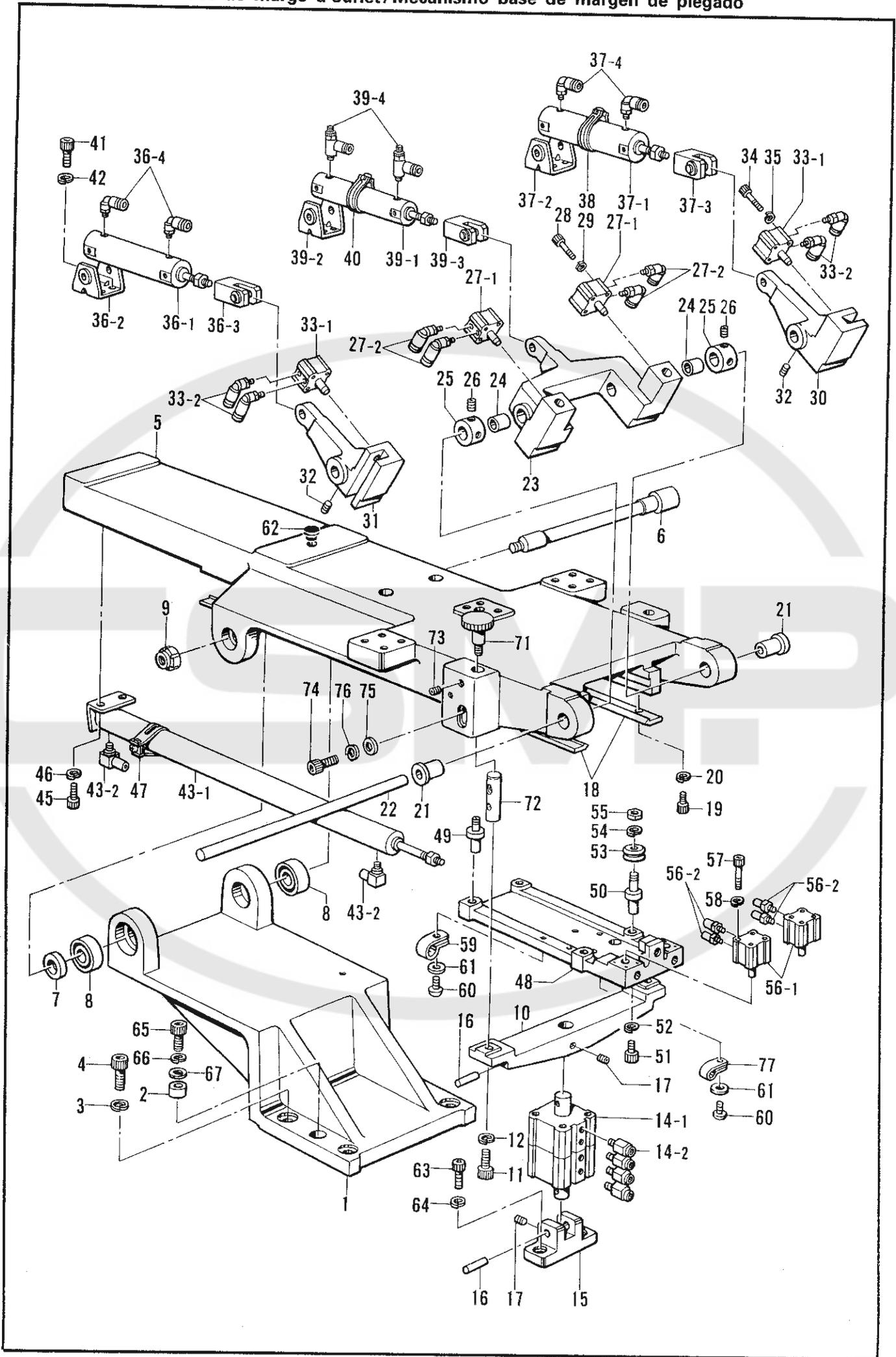
U. 折曲ゲ土台関係/Folding margin base mechanism/Faltungsvorrichtunggrundplatte/
