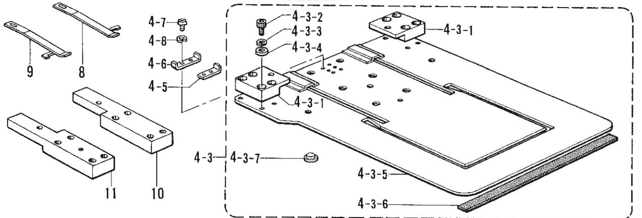
T. 折曲ゲ関係 (特別注文部品)/Folding margin mechanism (Option parts)/Faltungsvorrichtung (Sonderzubehör)/
