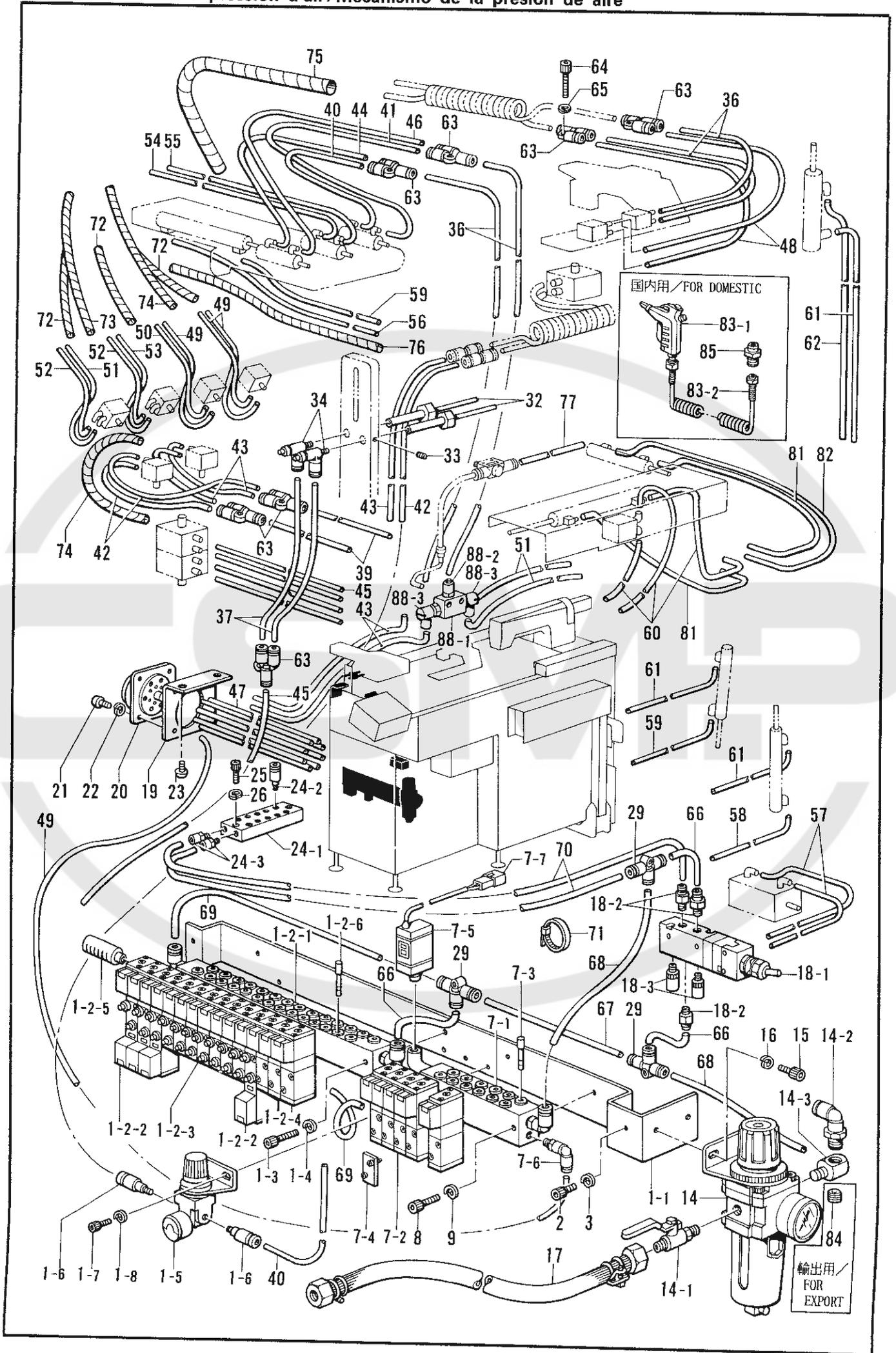
W. 空圧関係 / Air pressure mechanism / Luftdruck /
