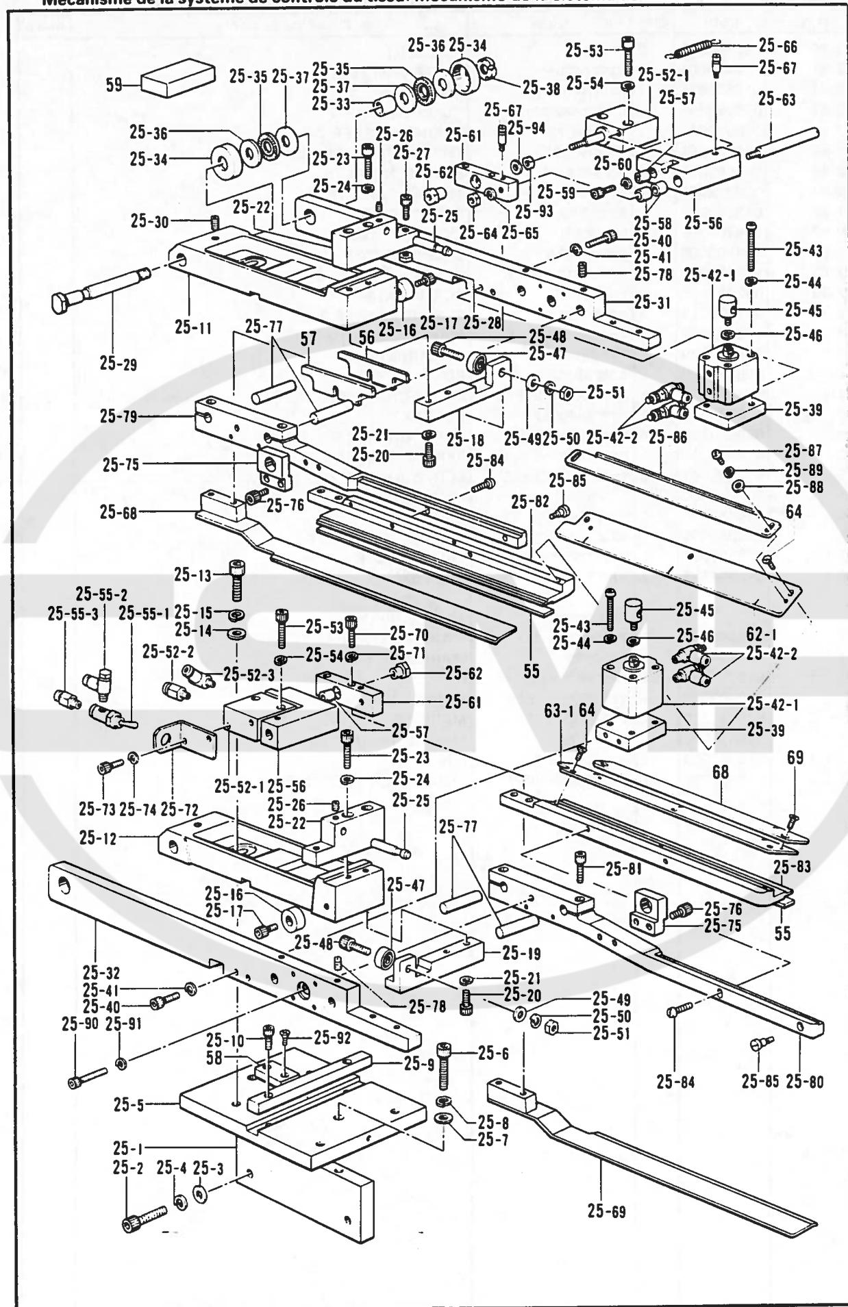
R3. 布制御関係 / Cloth control system mechanism / Stoffführungs vorrichtung /
