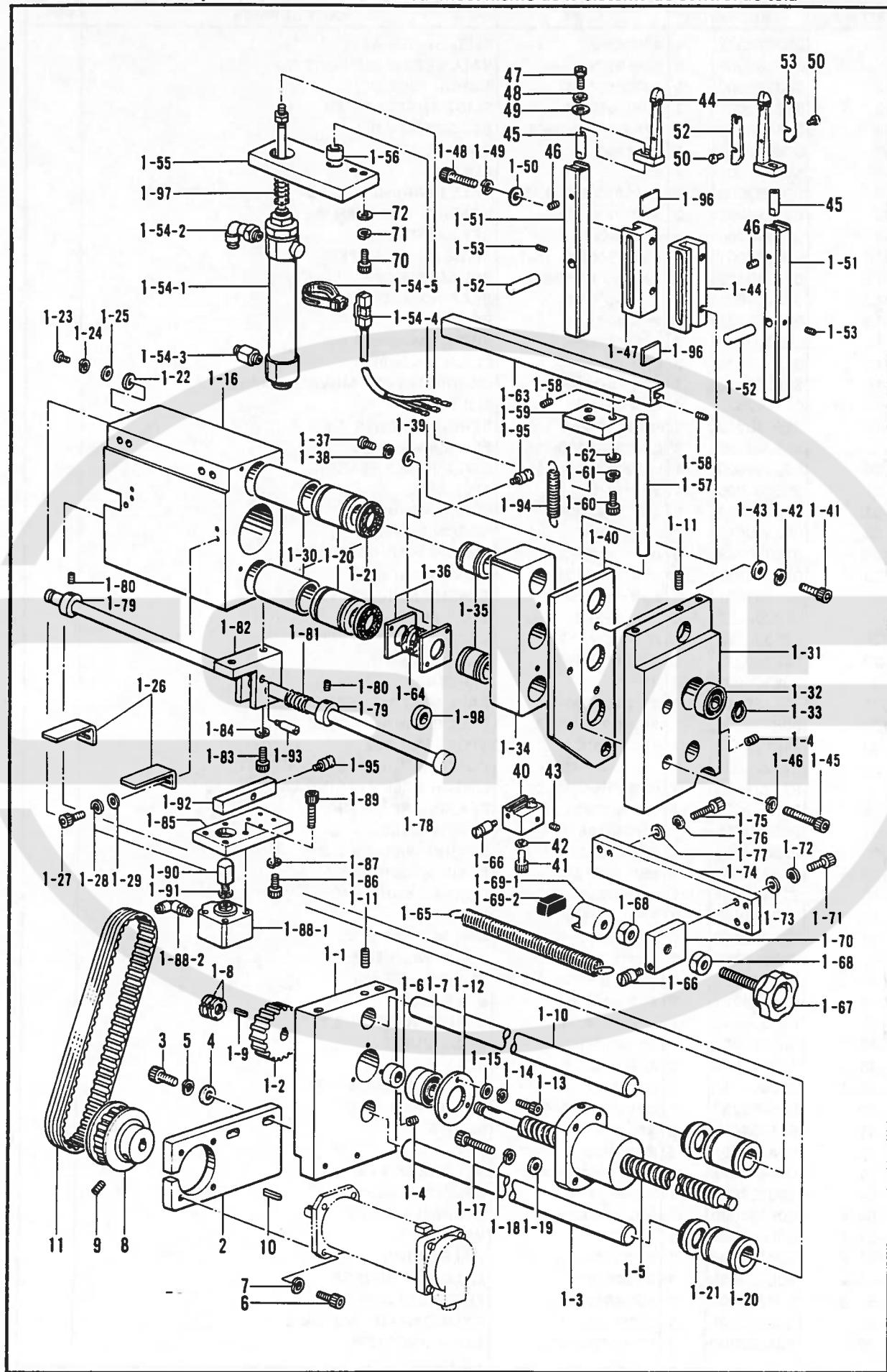
R1. 布制御関係 / Cloth control system mechanism / Stoffführungsvorrichtung /
