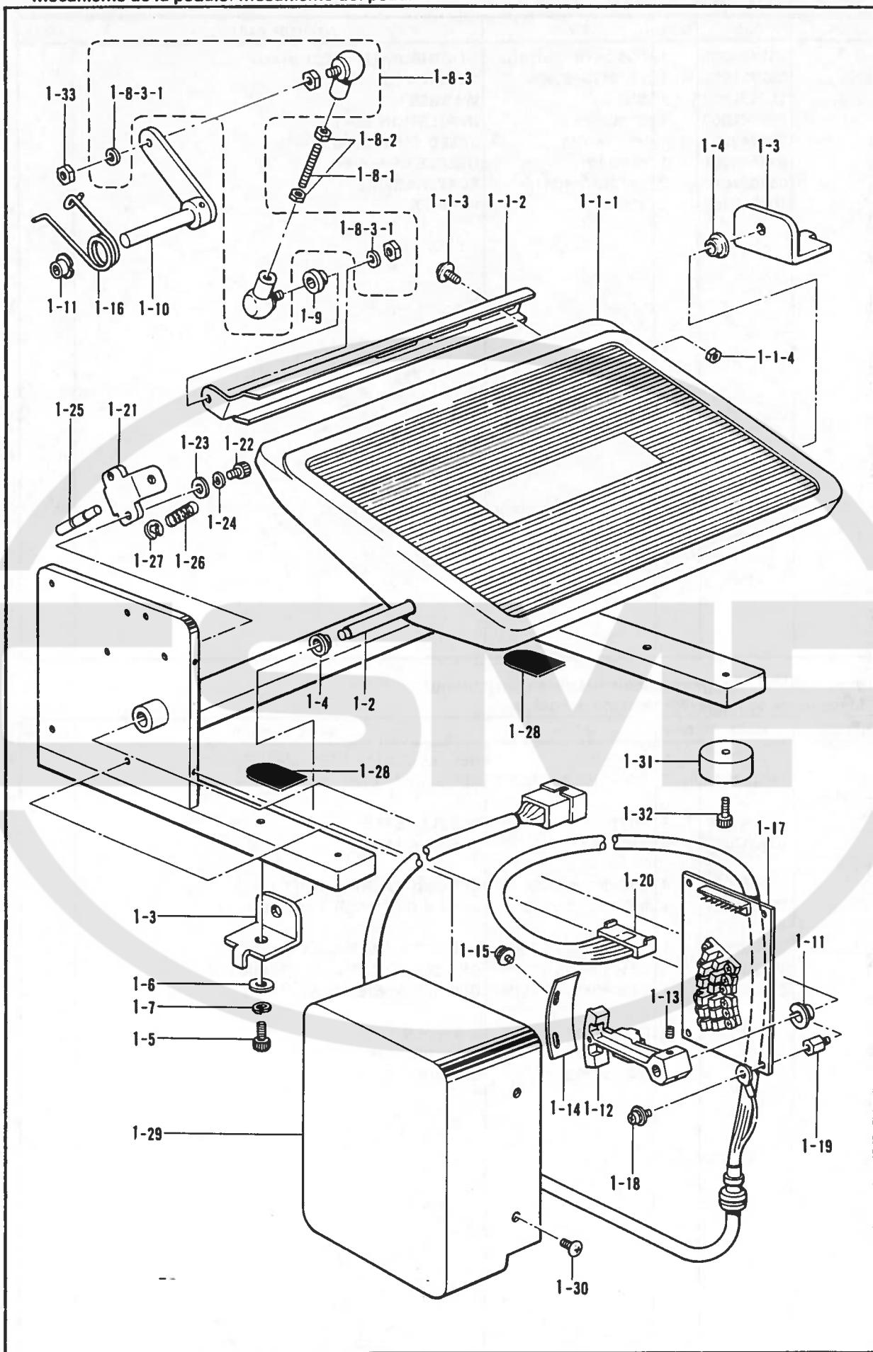
**U. 踏板関係/Foot switch pedal mechanism/Fußbetätigung/
