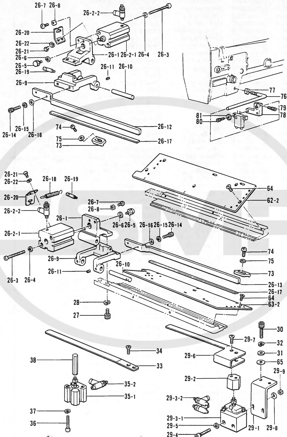
R4. 布制御関係 / Cloth control system mechanism / Stoffführungs vorrichtung /
