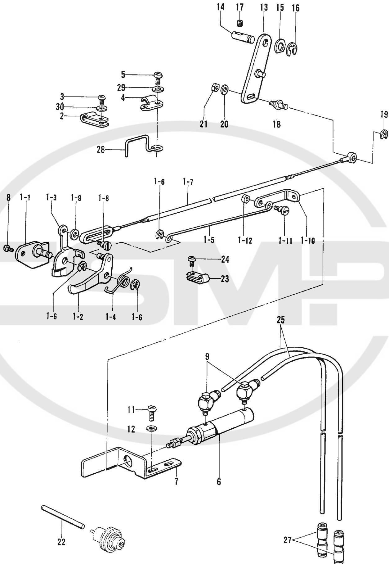
P. 糸締メ関係/Thread nipper mechanism/Fadenspannvorrichtung/
