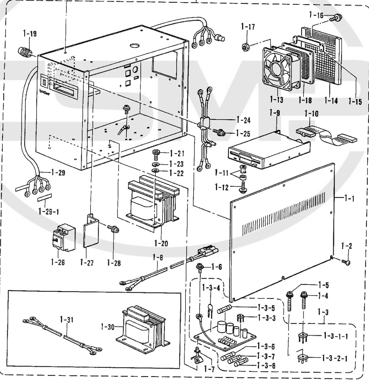
ルボックス関係 / Control box mechanism / Schaltkasten /
