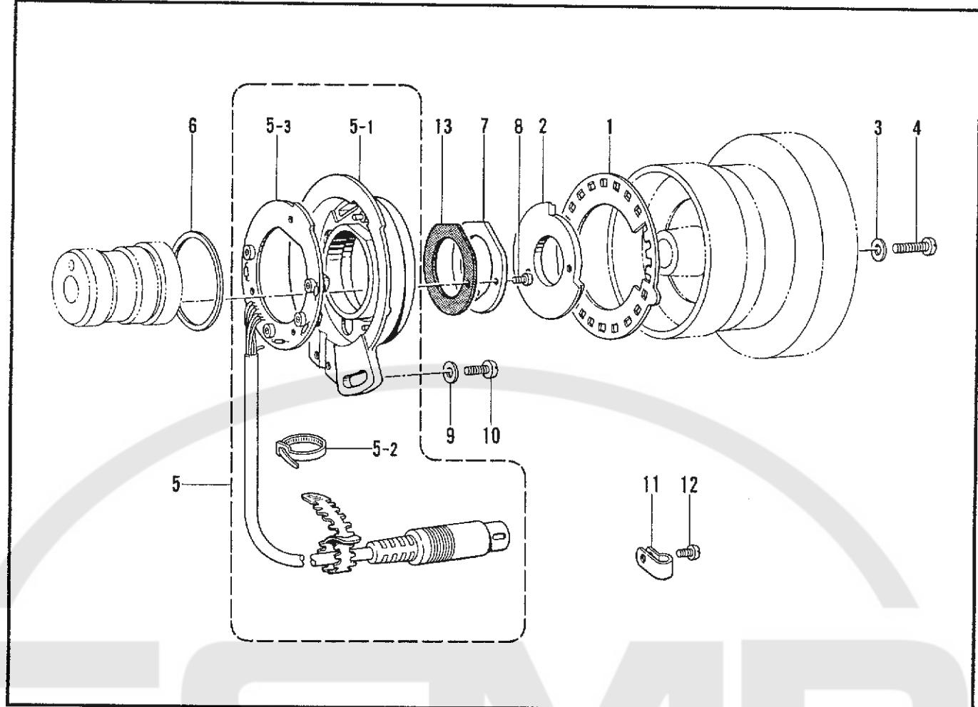
S. 踏板関係/Foot switch pedal mechanism/Fußbetätigung/
