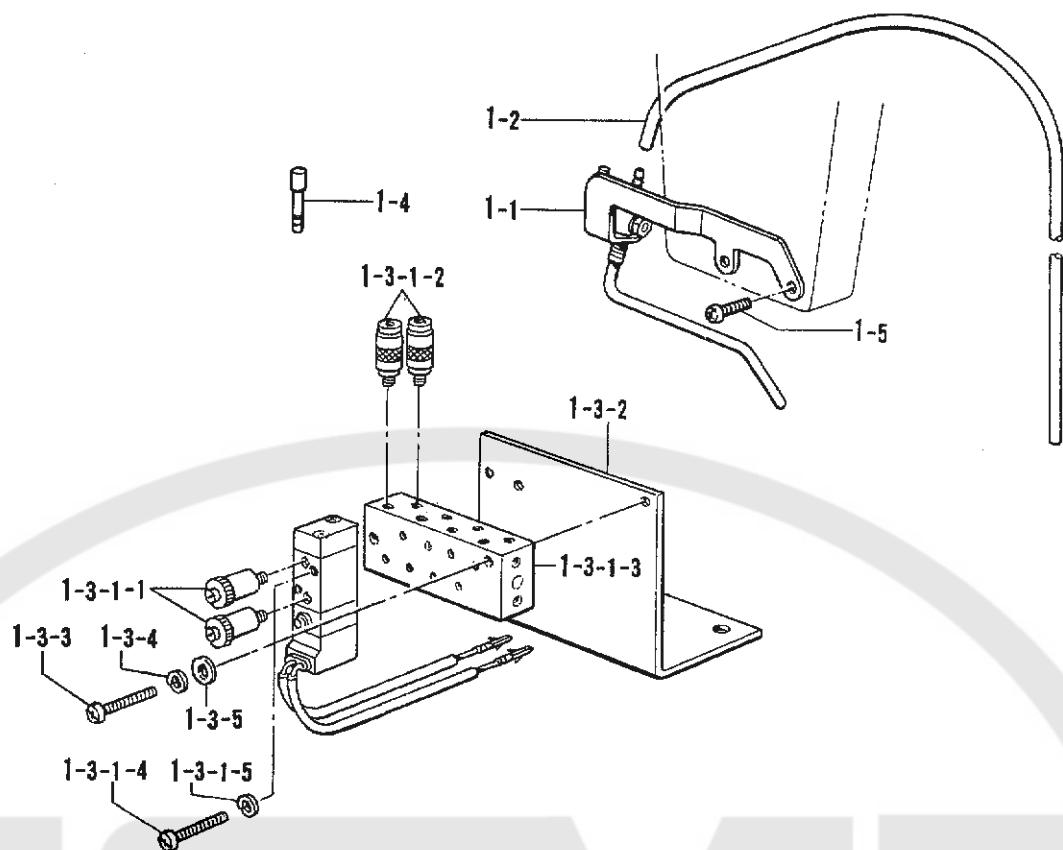
Y. 針冷却装置 /Needle cooler/Nadelkühlungsvorrichtung/
