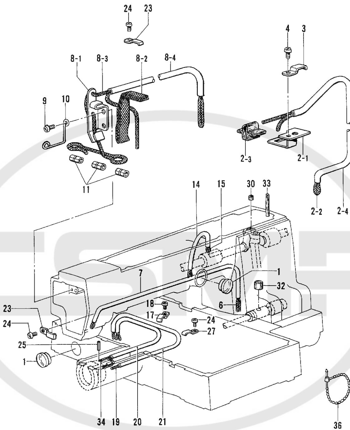
H. 給油潤滑関係 / Lubrication / Schmierung /
