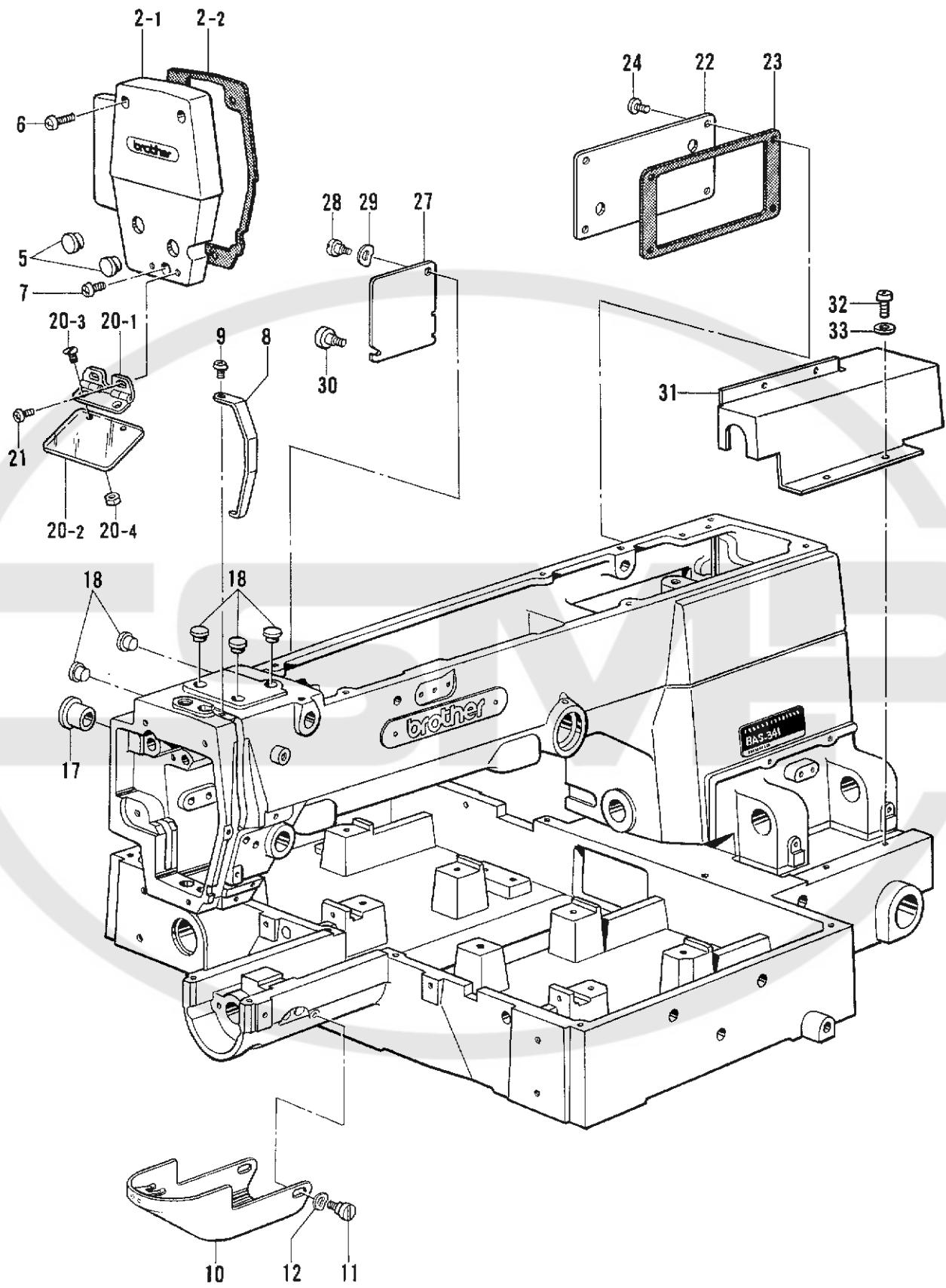
A. 主体関係(1)/Machine body (1)/Maschinengehäuse (1)/
