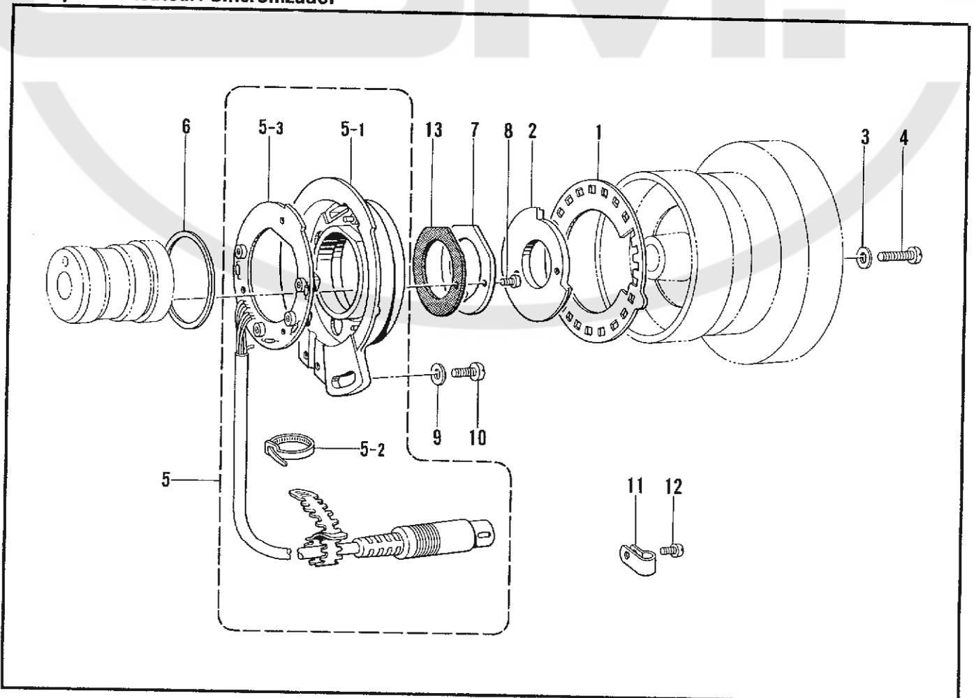
N. 糸締メ関係 / Thread nipper mechanism / Fadenspannvorrichtung /
