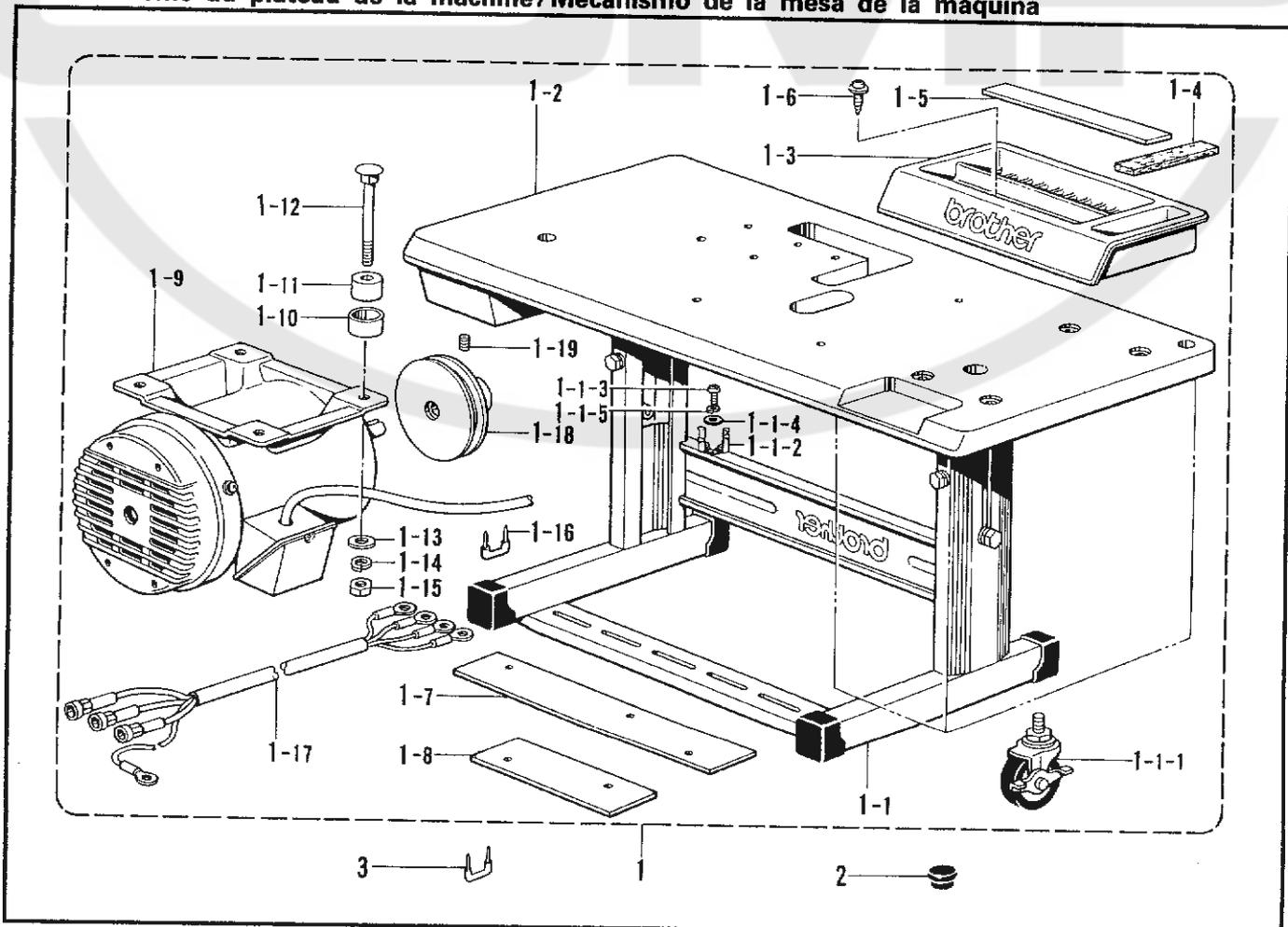
U. 踏板関係 / Foot switch plate mechanism / Fußbetätigung /
