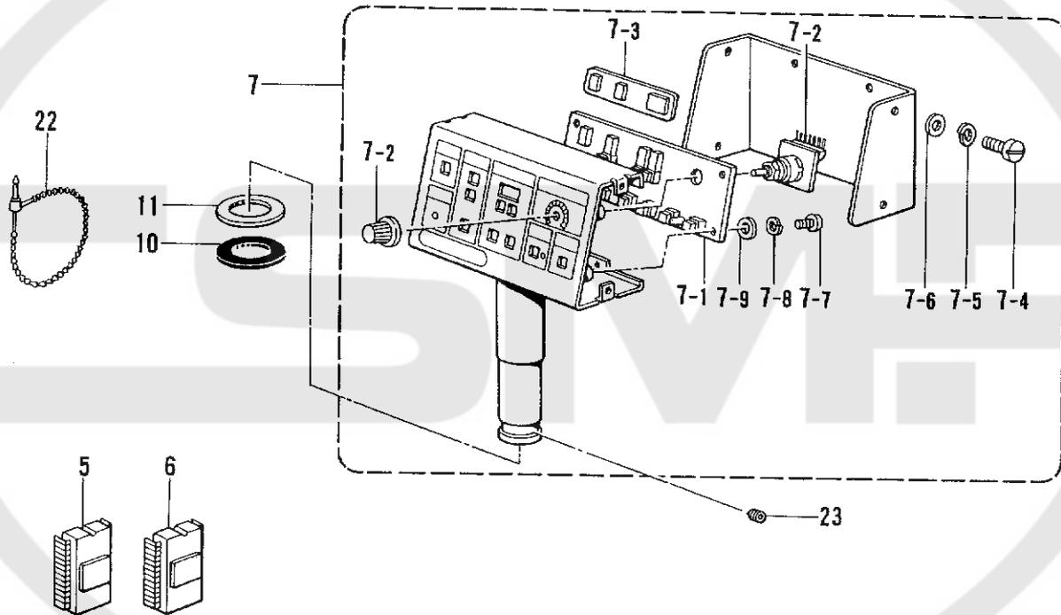
S. コントロールボックス関係/Control box mechanism/Schaltkasten/
