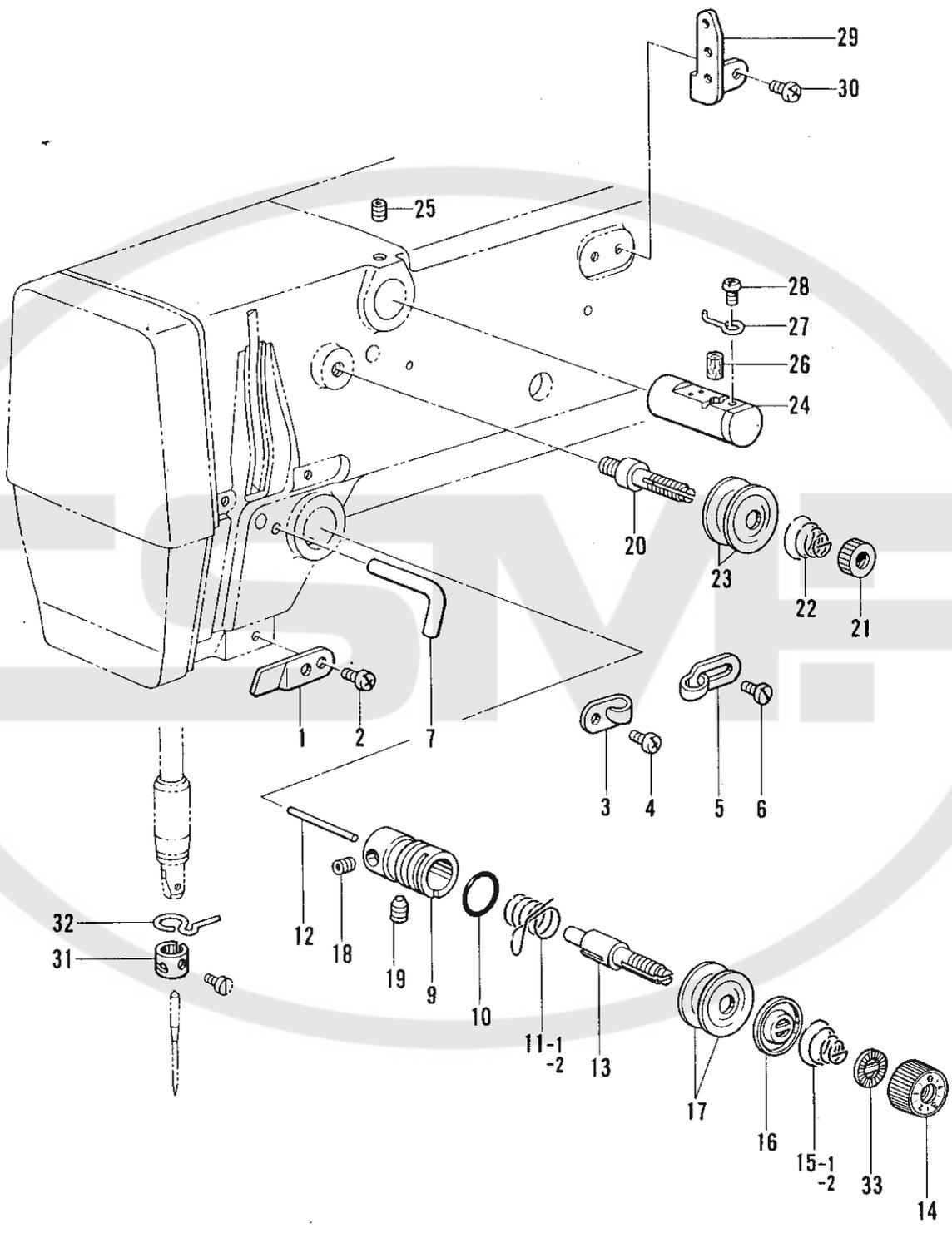
H. 糸通シ関係/Threading mechanism/FadenführungsVorrichtung/
