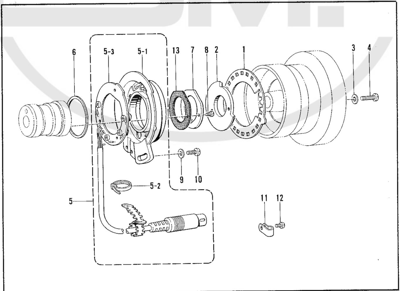
L. ワイパー関係/Thread wiper mechanism/Fadenwischvorrichtung/
